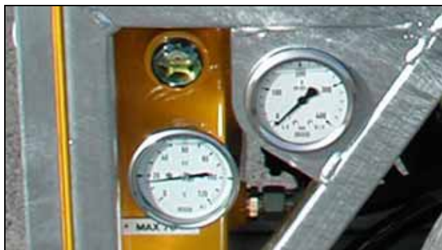
Рисунок 7.5 Масломерный указатель, манометр (контур двигателя диска), термометр масла (слева сверху, по часовой стрелке) на гидравлическом агрегате HAG-12.20/HAG-324
