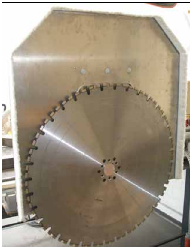
Рисунок 4.45 Готовность к резке заподлицо со стеной
