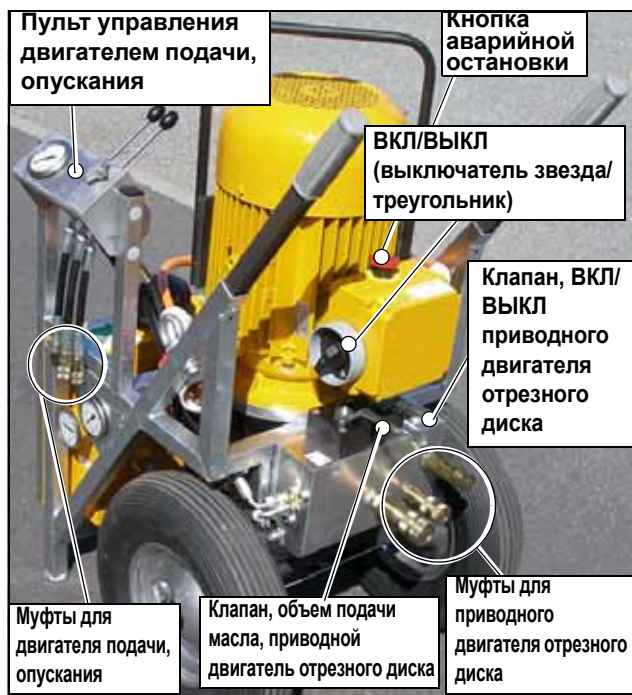
Рисунок 7.1 HAG•12.20, (HAG•324 с пультом управления гидравликой имеет аналогичное устройство)
