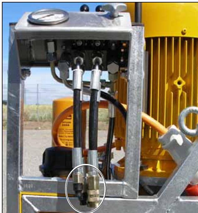
Рисунок 7.2 Муфты для гидравлических серводвигателей (подача, опускание) на пульте управления HAG•12.20 или HAG•324
