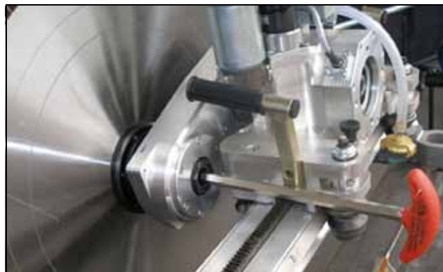
Рисунок 4.23 Фланец с отрезным диском прикрутить к поворотной консоли
