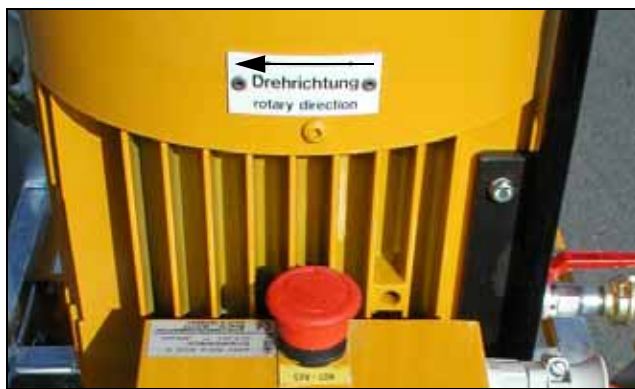
Рисунок 7.12 Стрелка направления вращения электродвигателя на HAG•12.20 / HAG•324
