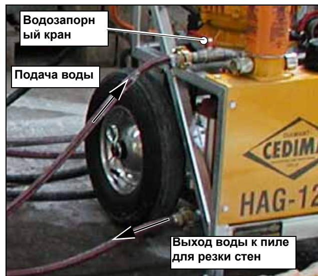
Рисунок 6.2 Подключение линии водоснабжения к гидравлическому агрегату HAG-12.20
