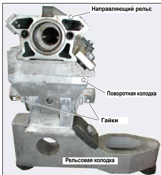
Рисунок 4.7 Поворотная колодка с направляющим рельсом смонтирована на рельсовой колодке 56 15
