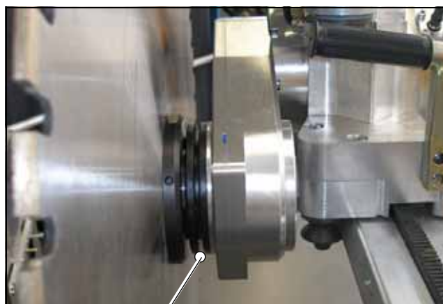
Рисунок 4.28 Направляющий паз для защиты отрезного диска на поворотной консоли
