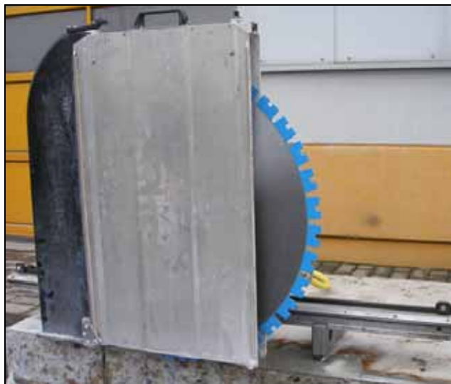
Рисунок 4.31 Смонтированы средняя секция и одна боковая секция защиты отрезного диска
