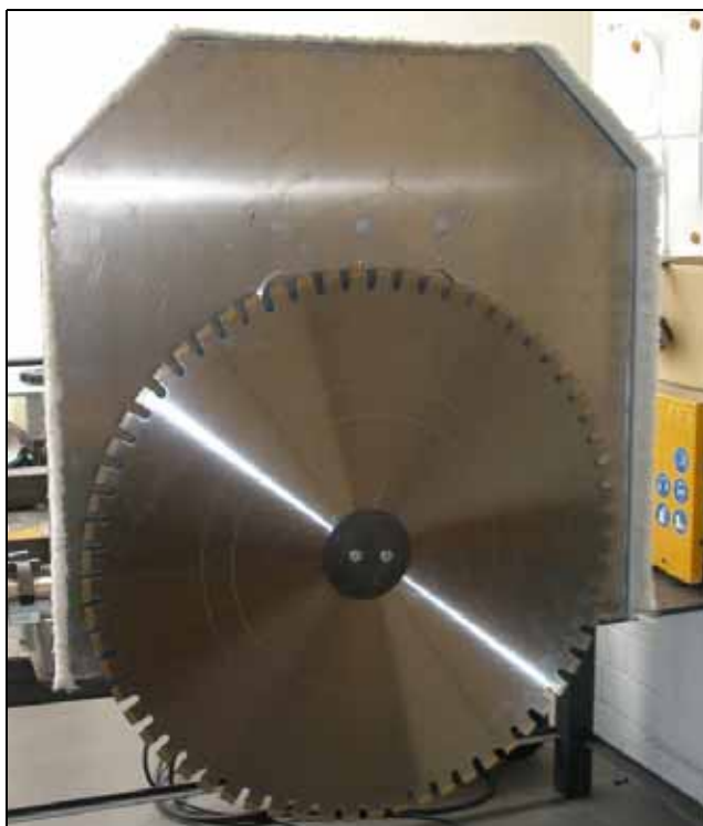
Рисунок 4.37 Готовность к резке "почти" заподлицо со стеной на расстоянии 16 мм
