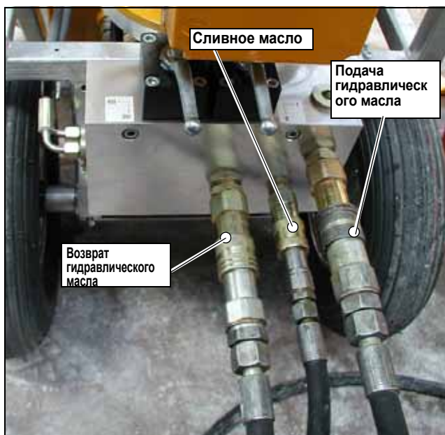
Рисунок 7.7 Гидравлические шланги от приводного двигателя отрезного диска подключены к HAG•12.20
