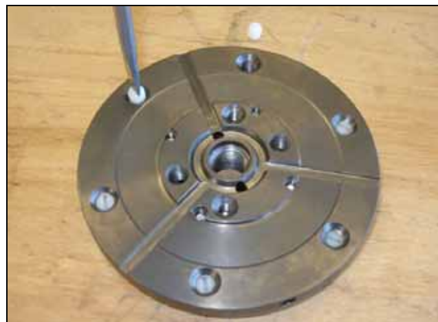
Рисунок 4.38 Предохранительные винты извлечь из фланца крепления отрезного диска для установки отрезного диска для резки заподлицо со стеной
