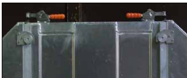
Рисунок 4.36 Боковые секции зажаты при помощи зажимного ригеля на защите отрезного диска 1200 мм
