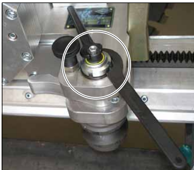
Рисунок 9.2 Регулировка направляющего ролика перпендикулярно направляющему рельсу
