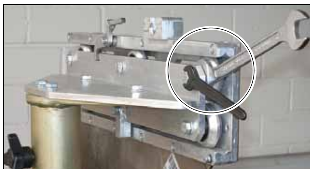
Рисунок 9.6 Регулировка зазора ходового ролика на раме держателя защиты диска
