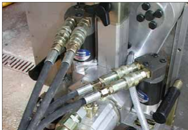
Рисунок 7.9 Гидравлический двигатель подачи и опускания отрезного диска подключен
