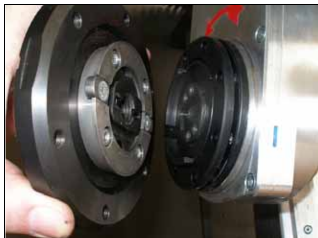
Рисунок 4.22 Установить фланец отрезного диска на поворотную консоль
