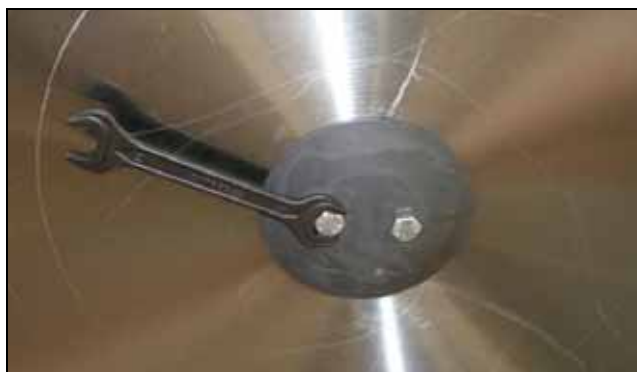
Рисунок 4.21 При помощи прижимного фланца зажать отрезной диск
