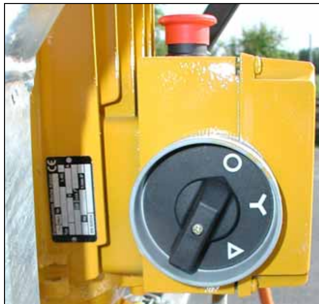
Рисунок 7.6 Выключатель ВКЛ/ВЫКЛ (звезда-треугольник) и кнопка аварийной остановки (вверху) на электродвигателе HAG-12.20 или HAG-324
