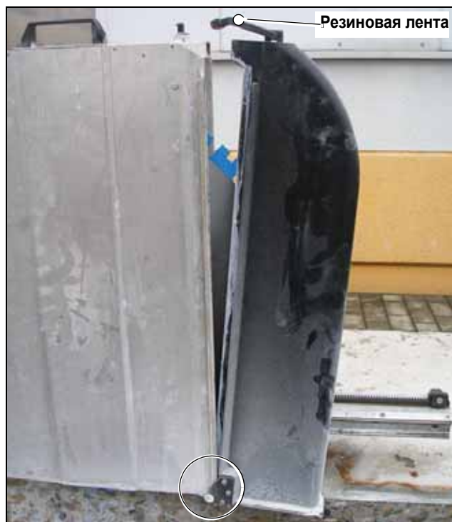
Рисунок 4.32 Отцепление и зацепление съемной боковой секции защиты отрезного диска
