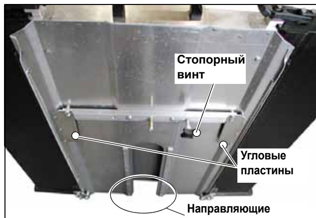
Рисунок 4.27 Направляющие и крепежные элементы на защите отрезного диска
