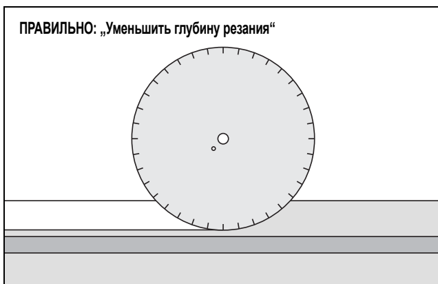
Рисунок 8.8 Уменьшить глубину резания при попадании на арматуру
