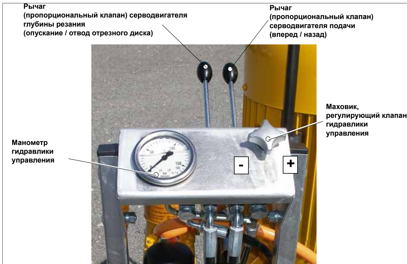
Рисунок 7.14 Элементы управления HAG•12.20, опциональном пульте управления HAG•324 в „исходном положении“
