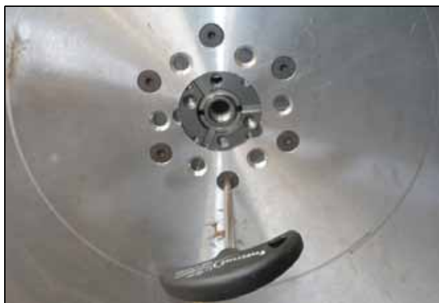
Рисунок 4.40Монтаж отрезного диска для резки заподлицо со стеной при помощи 6 специальных винтов на фланце крепления отрезного диска
