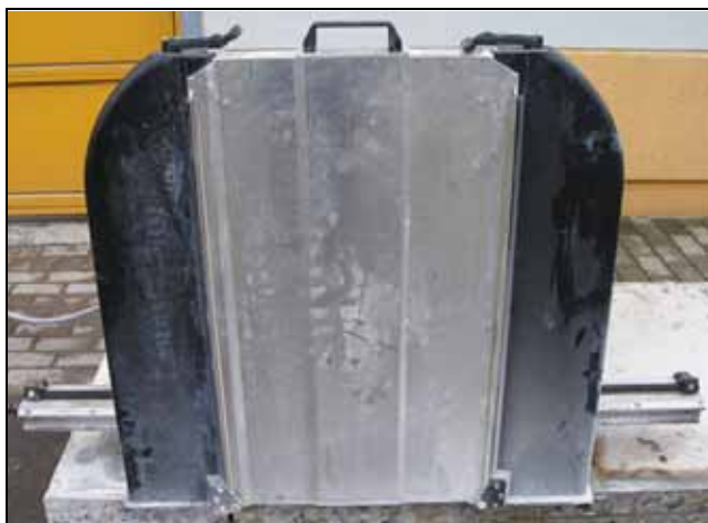
Рисунок 4.33 Защита отрезного диска полностью смонтирована
