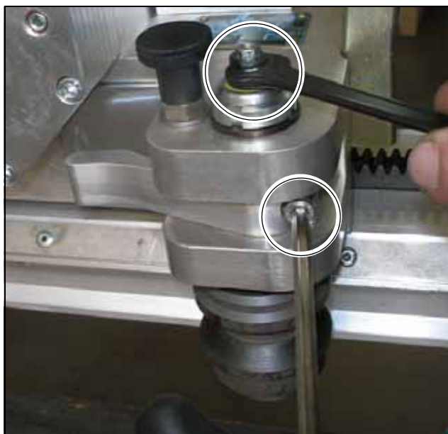
Рисунок 9.3 Регулировка направляющего ролика с боковой стороны относительно направляющего рельса
