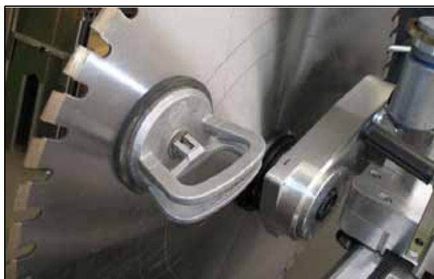
Рисунок 4.42Вакуумный захват для монтажа отрезного диска для резки заподлицо со стеной
