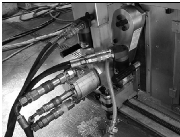
Рисунок 5.6 Гидравлическая пила для резки стен подключена к гидравлической системе
