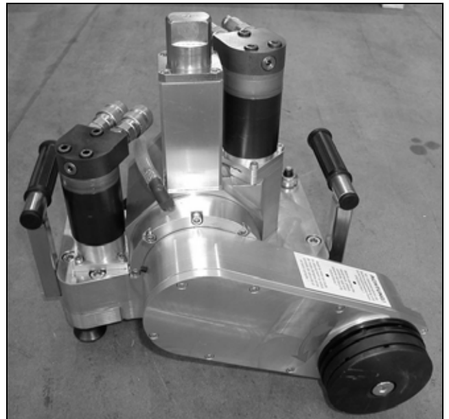
Рисунок 1.2 Корпус пилы WS-451 Н (сторона отрезного диска, WS-451 НН во многом похожа)
