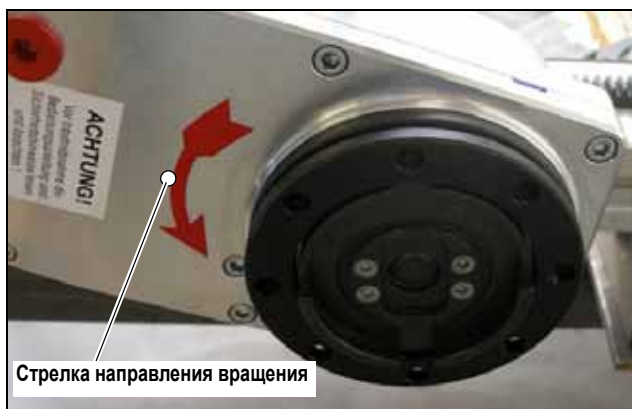
Рисунок 4.19 Патрон фланца отрезного диска на поворотной консоли
