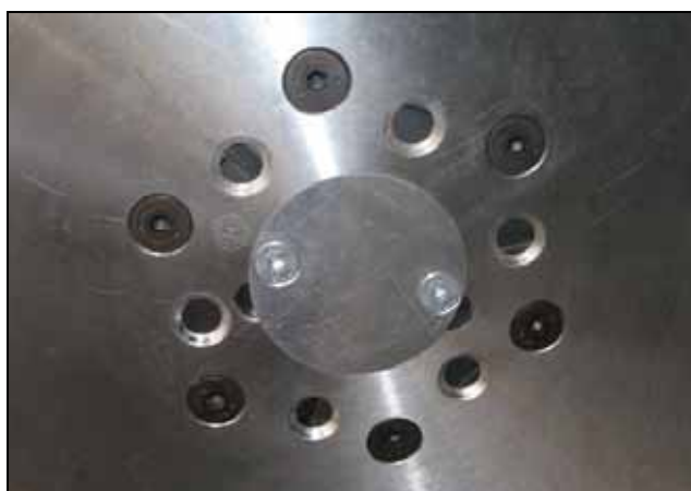
Рисунок 4.41Вставная пластина фланца отрезного диска смонтирована при помощи 2 винтов с потайной головкой
