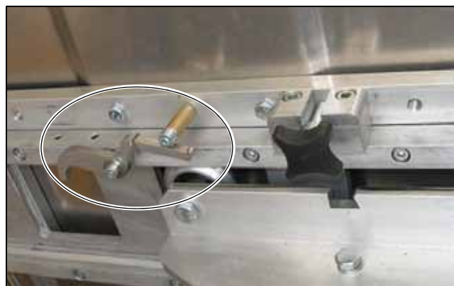
Рисунок 4.30 Средняя секция защиты отрезного диска задвинута на держатель защиты отрезного диска, транспортный фиксатор разблокирован, стопорный винт с крестовидной ручкой затянут
