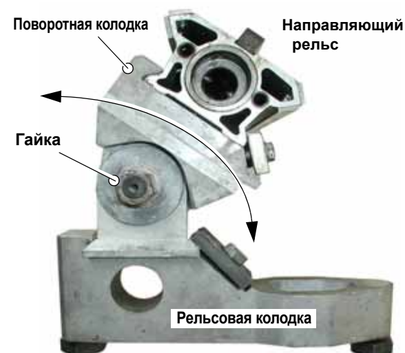
Рисунок 4.8 Поворотная колодка повернута в поперечном направлении рельса
