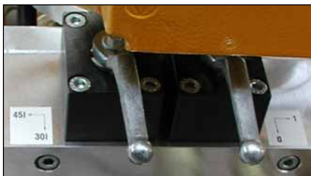
Рисунок 7.4 Рычаг (слева), объем подачи масла, рычаг (справа), ВКЛ (1)/ВЫКЛ (0) гидравлического приводного двигателя отрезного диска на HAG-12.20 или HAG-324
