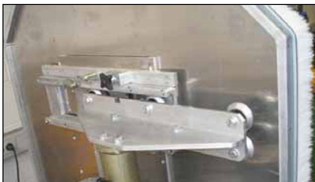
Рисунок 4.44 Защита отрезного диска для резки заподлицо со стеной смонтирована
