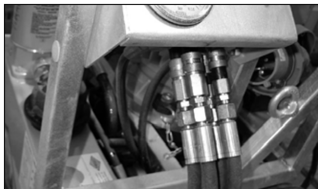
Рисунок 7.10 Гидравлические шланги гидравлических серводвигателей (подача, опускание) подключены к пульту управления HAG•12.20 / HAG•324 (короткие соединения пульта управления)
