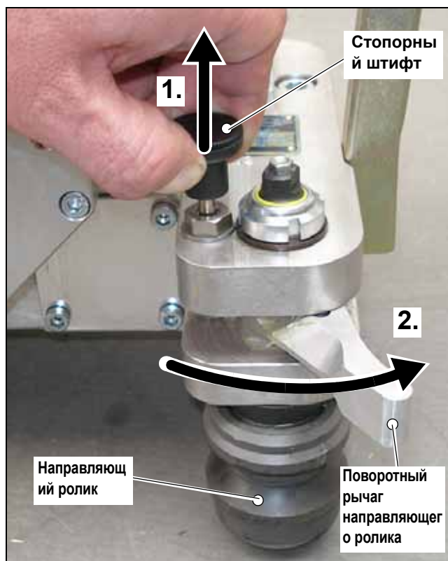
Рисунок 4.14 Разблокировка и выдвижение (правого) направляющего ролика
