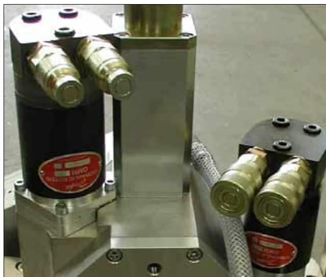
Рисунок 7.8 Муфты на гидравлическом двигателе подачи и опускания отрезного диска
