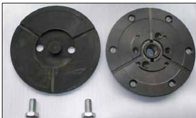
Рисунок 4.18 Прижимной фланец диска демонтирован
