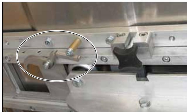
**Рисунок 4.30** Средняя часть кожуха установлена на держатель, транспортный фиксатор ослаблен, барашковый фиксирующий вит зажат
