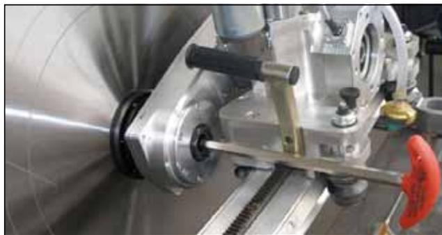
**Рисунок 4.23** Привинчивание крепежного фланца с диском к поворотной консоли
