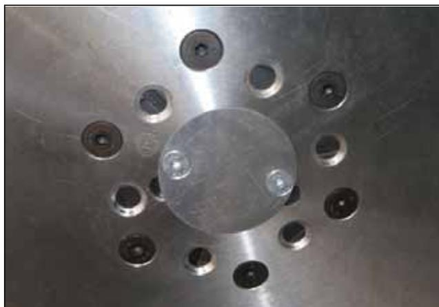
**Рисунок 4.41** Смонтированная вставка фланца диска с 2 болтами с потайной головкой
