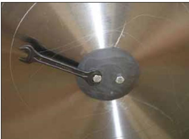
**Рисунок 4.21** Прижим режущего диска прижимным фланцем
