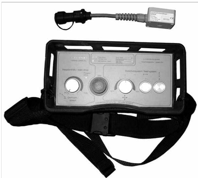
Рисунок 8.3 Универсальный радиоприемник UFE•01 и универсальный пульт радиуправления USF•01 F
