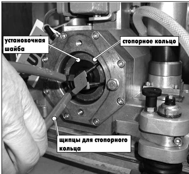
Рисунок 6.3 Подготовка корпуса пилы к монтажу HFM•18
