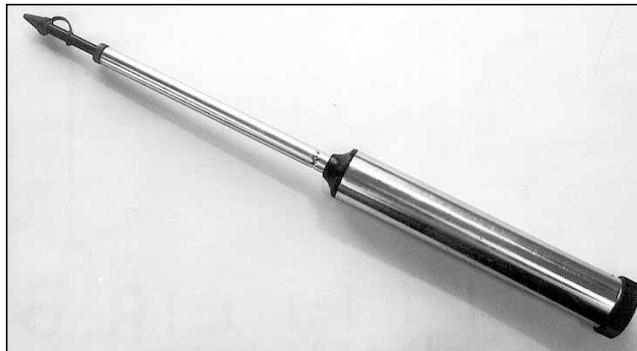
**Рисунок 2.1** Ручной смазочный шприц
