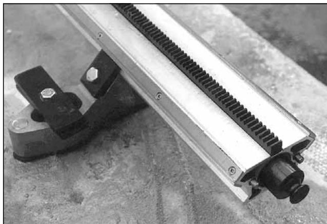
**Рисунок 4.1** Направляющий рельс, смонтированный на колодке
