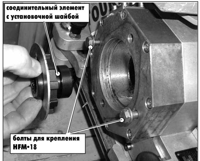
Рисунок 6.4 Установка в корпус пилы соединительного элемента для монтажа HFM•18
