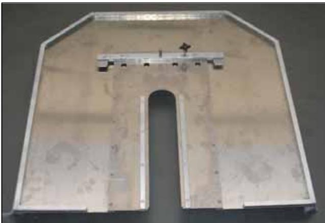
**Рисунок 4.43**Кожух диска "заподлицо со стеной"
