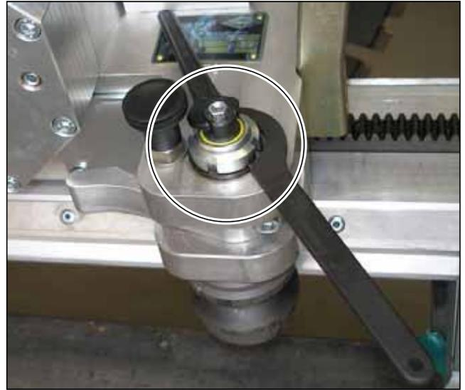
**Рисунок 11.2** Регулировка ролика относительно рельса по вертикали
