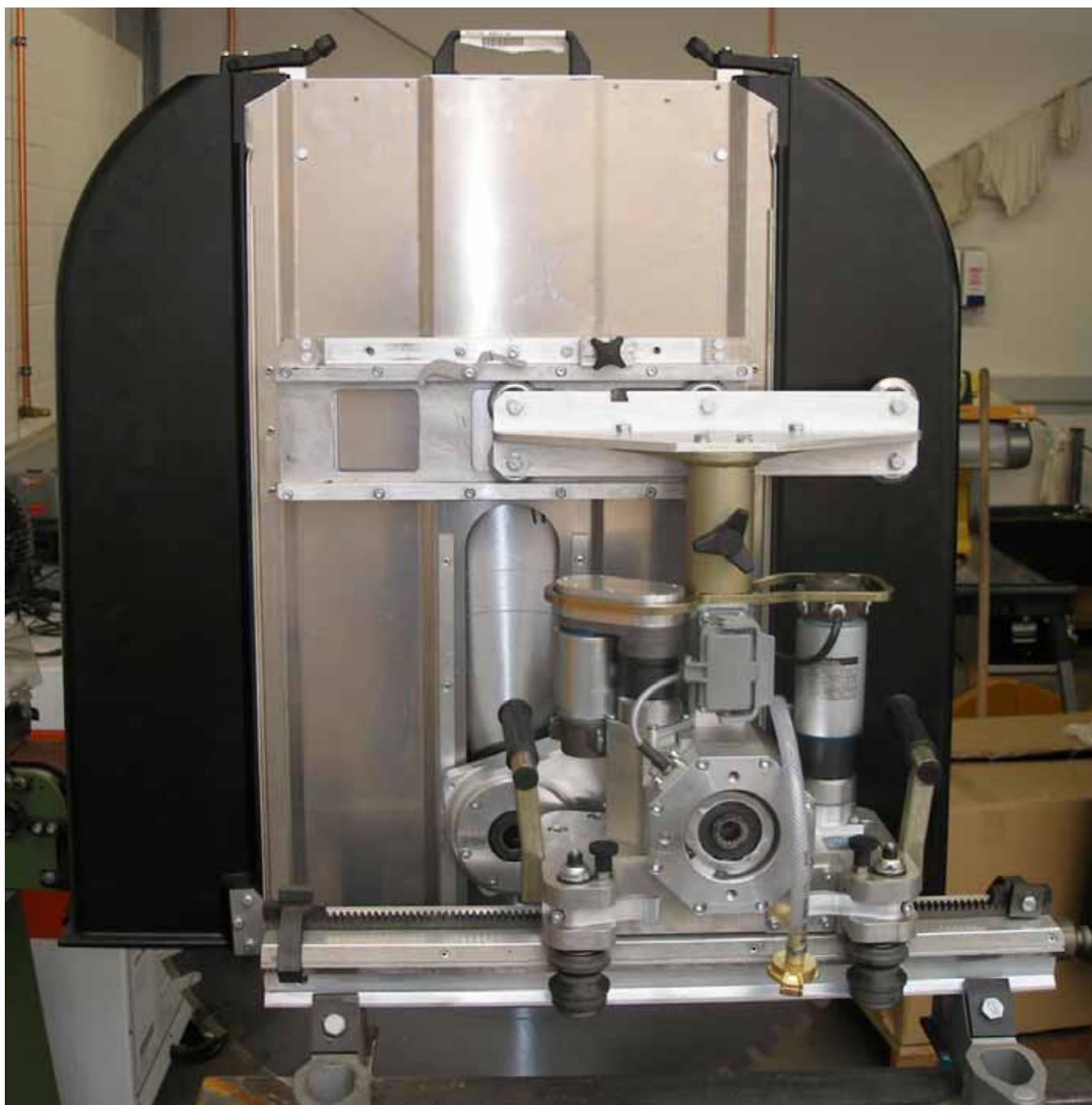
**Пила для резки стен WS-451 EE, без двигателя привода диска**
