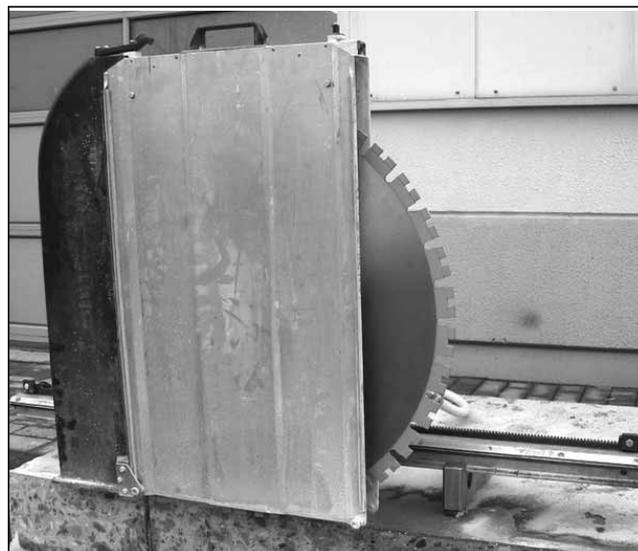
**Рисунок 4.31** Смонтированные средняя часть и одна из боковин кожуха диска
