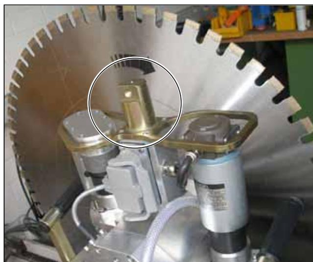
**Рисунок 4.26 Посадочная шейка для держателя кожуха диска**
