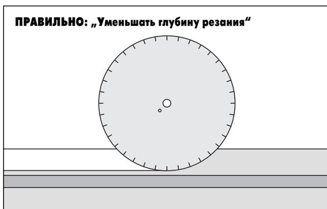
Рисунок 10.8 Уменьшать глубину резания
