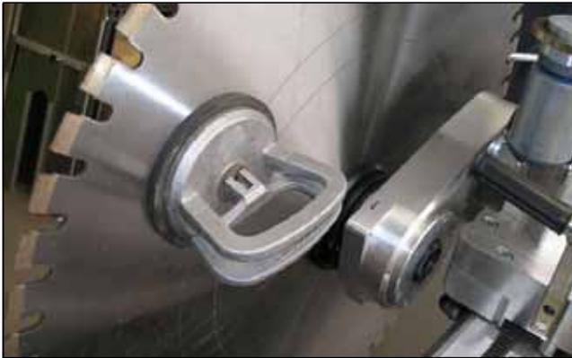
**Рисунок 4.42**Присосный захват для установки режущего диска "заподлицо со стеной"
