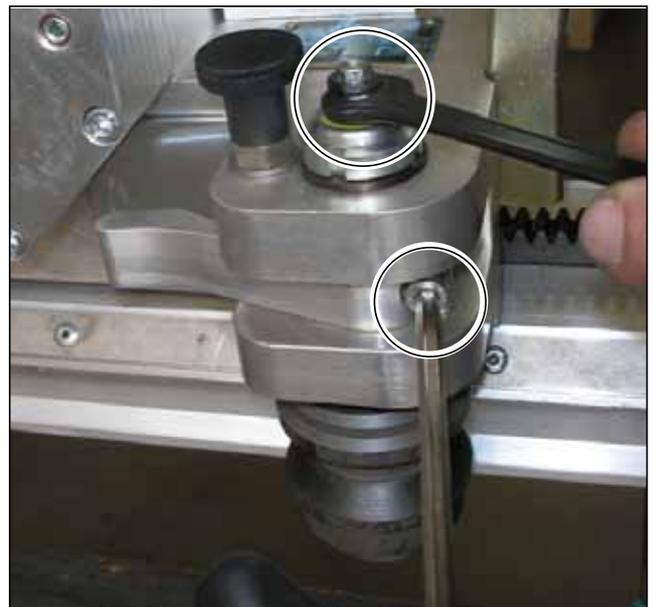
**Рисунок 11.3** Регулировка ролика относительно рельса по горизонтали
