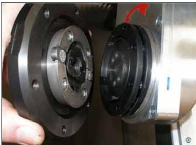
**Рисунок 4.22** Установка фланца диска на поворотную консоль
