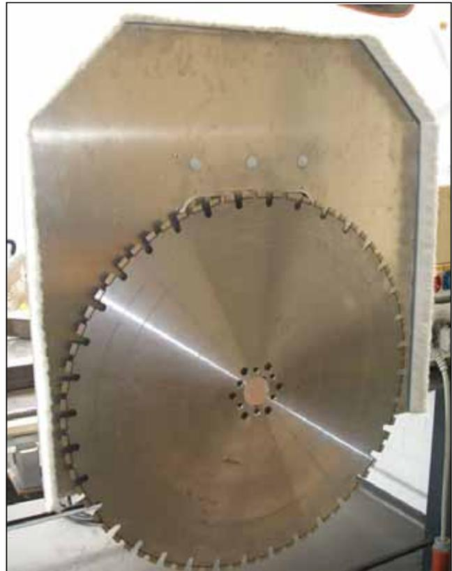
**Рисунок 4.45**Готовность к резке "заподлицо со стеной"
