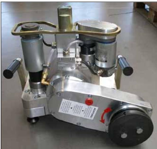
**Рисунок 1.1** Корпус пилы **WS-451 EE / WS-451 EH** с точно регулируемыми электродвигателями для подачи и подвода (на глубину резания) Вид со стороны поворотной консоли с фланцем крепления диска
