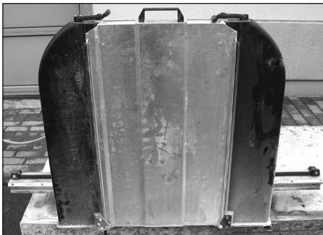
**Рисунок 4.33**Полностью смонтированный кожух диска
