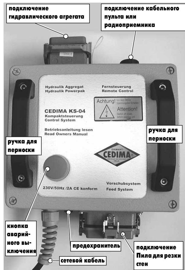
Рисунок 8.1 Компактный блок управления KS•04
