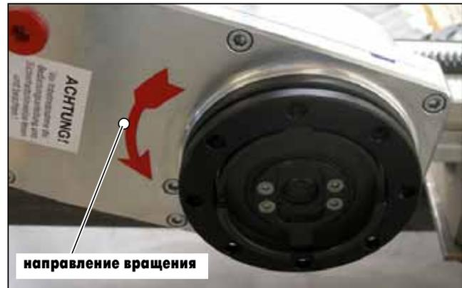
Рисунок 4.19 Крепление для фланца диска на поворотной консоли
