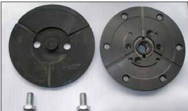
Рисунок 4.18 Демонтированный прижимной фланец
