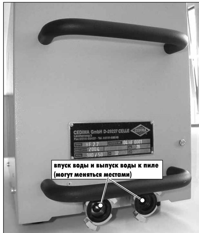
**Рисунок 7.5** Соединения для водопроводов на универсальном блоке управления HF-27.1
