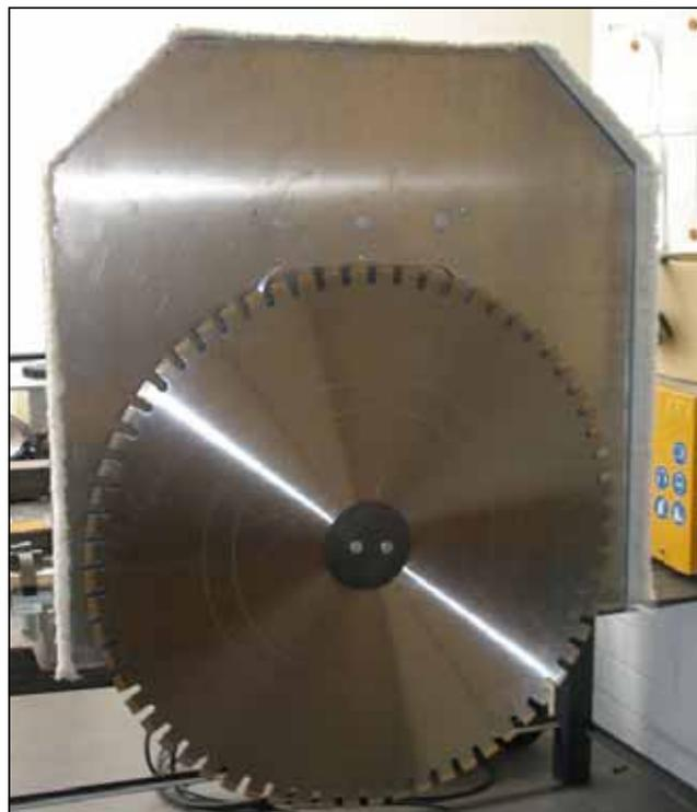
**Рисунок 4.37** Готовность к резке "почти заподлицо со стеной" с расстоянием 16 мм
