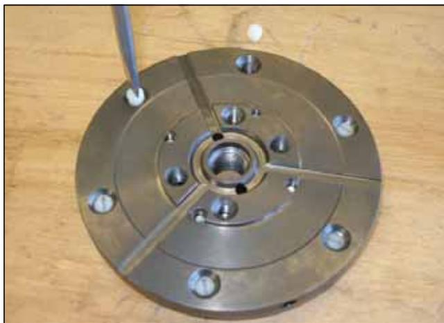
**Рисунок 4.38** Удаление резьбовых заглушек из крепежного фланца для установки режущего диска "заподлицо со стеной"
