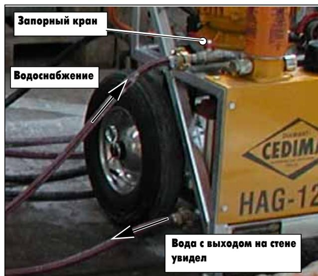
Рисунок 7.2 Схема подсоединения водопроводов HAG-12.10
