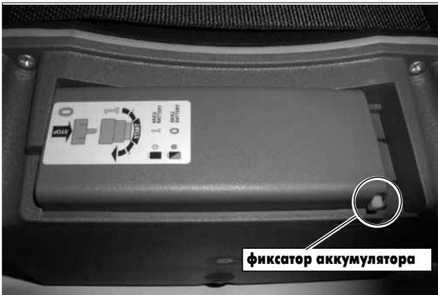
Рисунок 8.5 Аккумулятор в радиопульте
