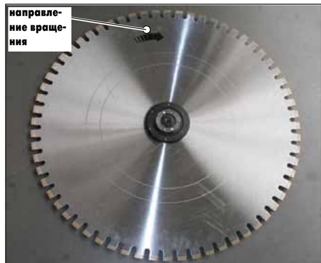
Рисунок 4.20 Крепежный фланец с режущим диском
