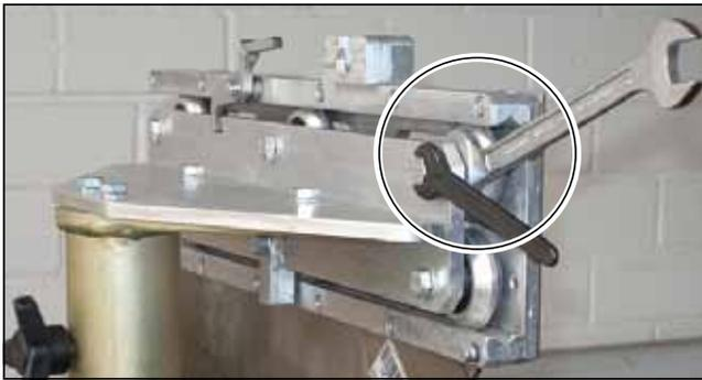
**Рисунок 11.6** Регулировка люфта ходовых роликов рамы держателя защитного кожуха диска
