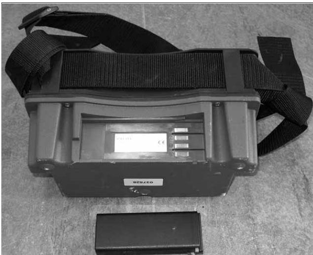
Рисунок 8.6 Аккумулятор, извлеченный из радиопульта
