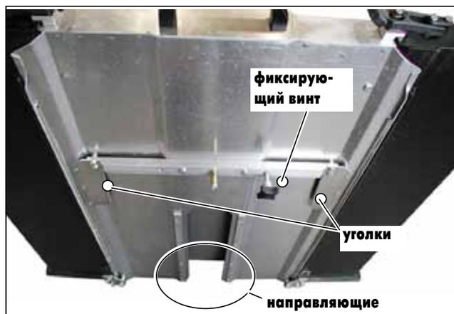
**Рисунок 4.27 Направляющие и крепежные элементы защитного кожуха диска**
