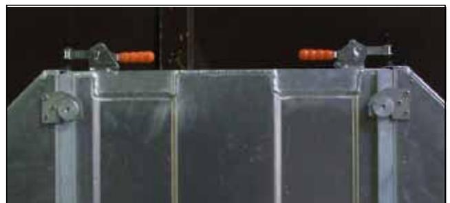
**Рисунок 4.36** Боковины защитного кожуха диска 1200 мм, зажатые замками
