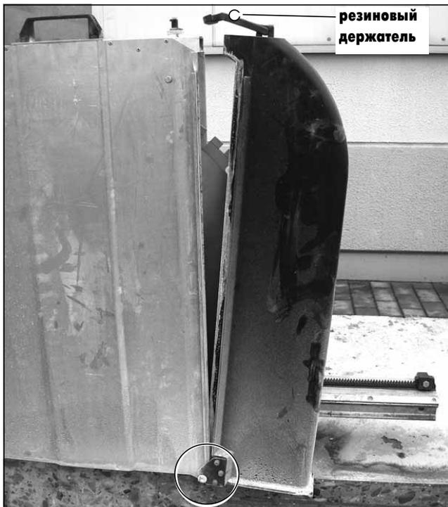
**Рисунок 4.32**Монтаж / демонтаж съемной боковины кожуха диска
