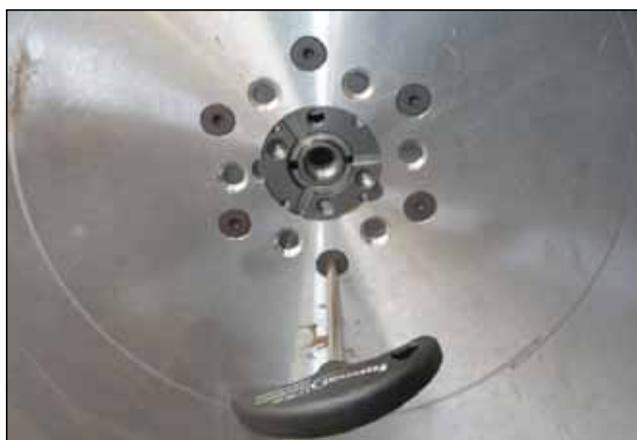
**Рисунок 4.40** Установка диска для резки "заподлицо со стеной" на крепежный фланец с помощью 6 специальных болтов
