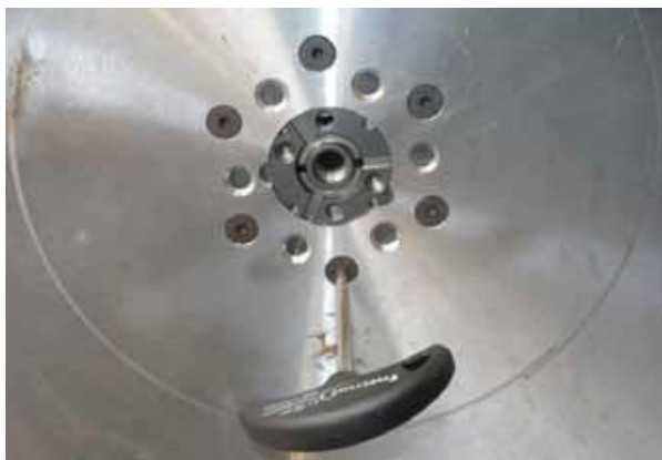
Рис. 7.30: Монтаж диска для резки вплотную к стене с помощью 6 специальных винтов на фланце крепления режущего диска
