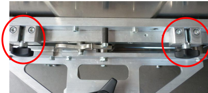
Рис. 7.25: Закрепление средней части кожуха диска правым винтом с крестообразными ручками на держателе кожуха
