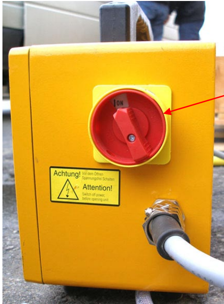
Рис. 4.19: HF-17 главный выключатель включен в положение „I“ (ON)
