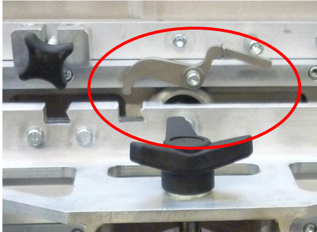
Рис. 7.24: Средняя часть кожуха насажена на держатель кожуха. Фиксатор разомкнут
