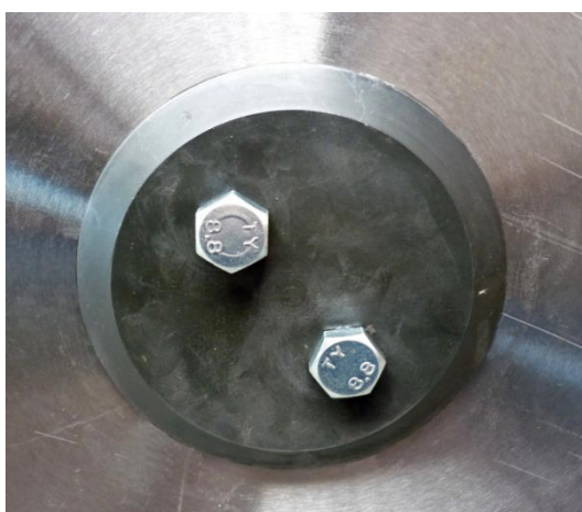
Рис. 7.15: Режущий диск с смонтированным (внешняя сторона) прижимным фланцем
