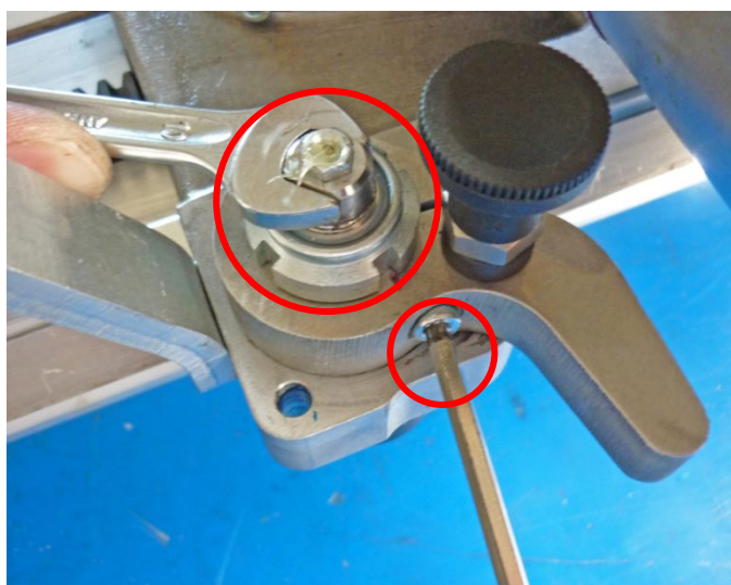
Рис. 10.3: Регулировка направляющего ролика сбоку к направляющей шине
