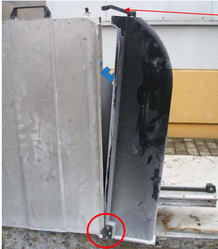
Рис. 7.26: Снятие и навешивание съемной боковой части кожуха диска
