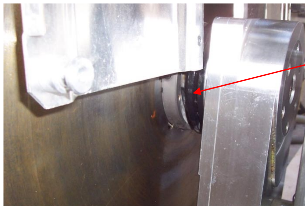
Рис. 7.22: Направляющий паз для кожуха диска в режущем рукаве
