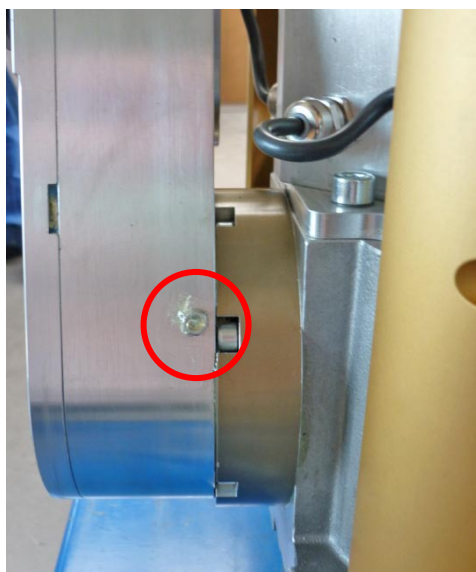
Рис. 10.2: Пресс-маслёнка на подшипнике режущего рукава
