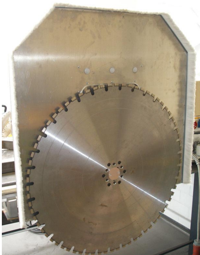
Рис. 7.27: Смонтированный защитный кожух для резки вплотную к стене
