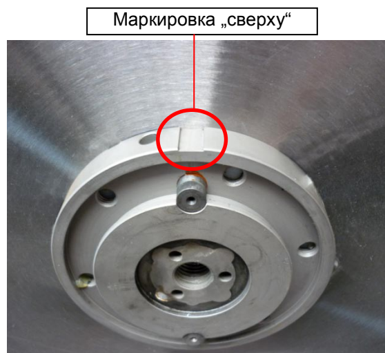
Рис. 7.16: Режущий диск с смонтированным фланцем крепления (задняя сторона)
