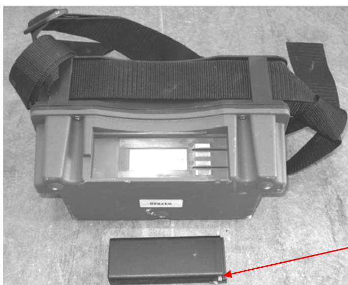
Рис. 4.9: : Аккумулятор вынут из радиопульта управления USF-01 F
