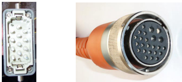
Рис. 4.16: Штекер к HF-17 и розетка к WS-296 на соединительном кабеле
