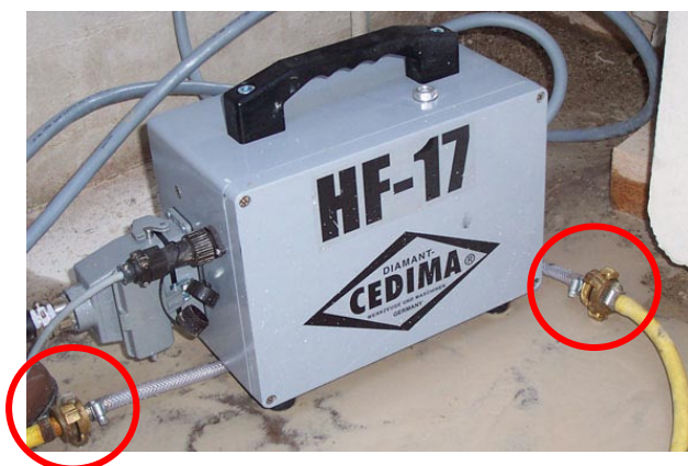
Рис. 4.3: HF-17 к HF-17 подключена подача охлаждающей воды
