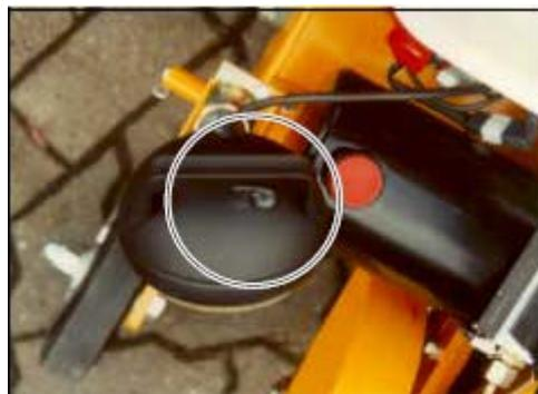
**Рисунок 4.11. Переключатель на фаре (модель CF-206.2 В)**
