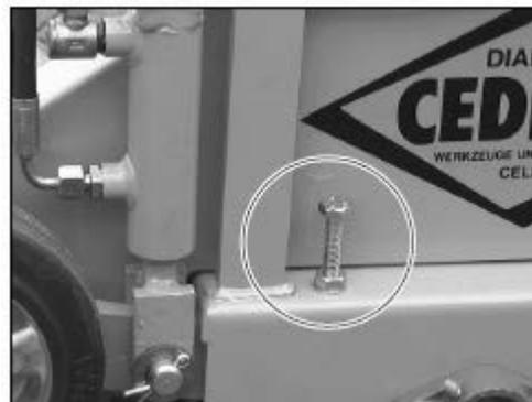
**Рисунок 4.7. Глубинный упор**
