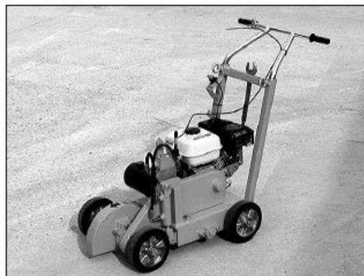
**Рисунок 1.2. Машина для снятия фасок CF-206.1 В с двигателем Honda GX390**
