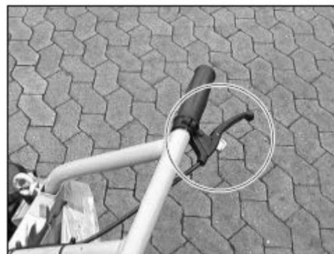
**Рисунок 4.9. Рукоятка для подъёма (с фиксатором)**
