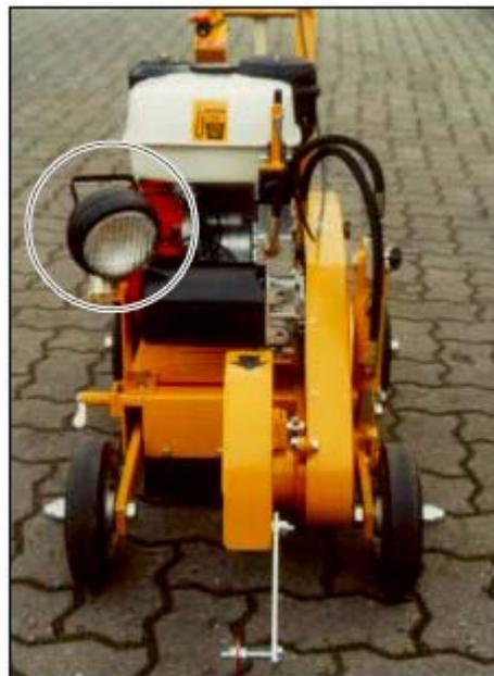
**Рисунок 4.10. Фара / прожектор на модели CF-206.2 В**
