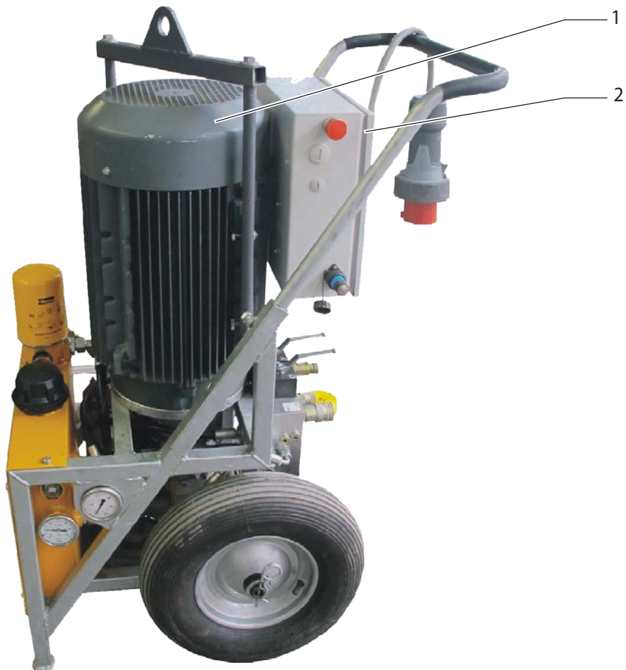
Рис. 1 Расположение защитных устройств
