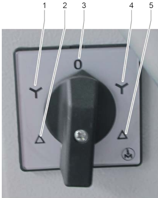
Рис. 16: Главный выключатель в виде переключателя звезда-треугольник
