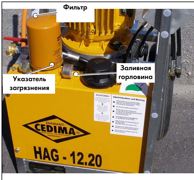
Рис. 4.2 Заливная горловина с сеткой-фильтром, фильтр с указателем загрязнения, спереди на HAG•12.20
