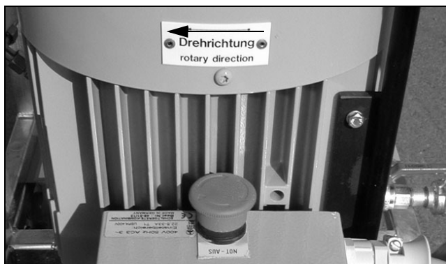
Рис. 5.1 Указатель направления вращения на HAG•12.20 (над аварийной кнопкой)
