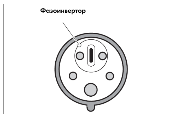
Рис. 5.2 Фазоинвертор в СЕЕ штекере маслостанции
