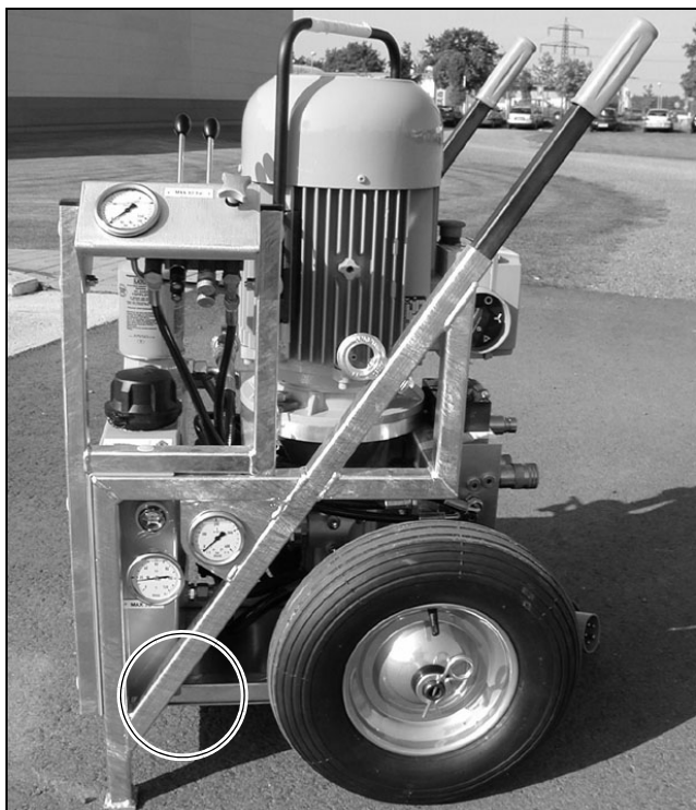
Рис. 6.1 Место сливной пробки на HAG•12.20
