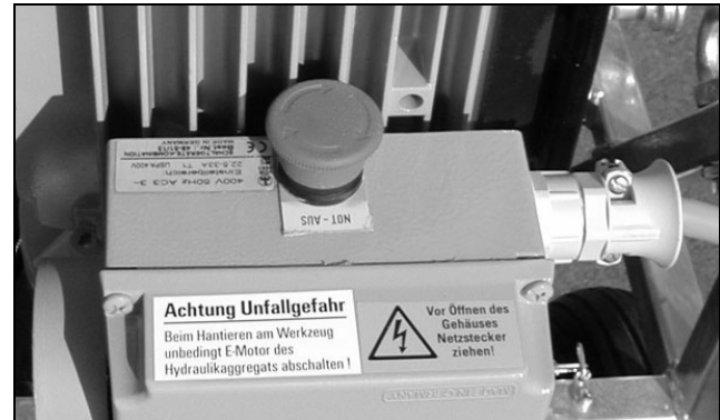
Рис. 4.4 Аварийная кнопка на корпусе главного выключателя HAG•12.2
