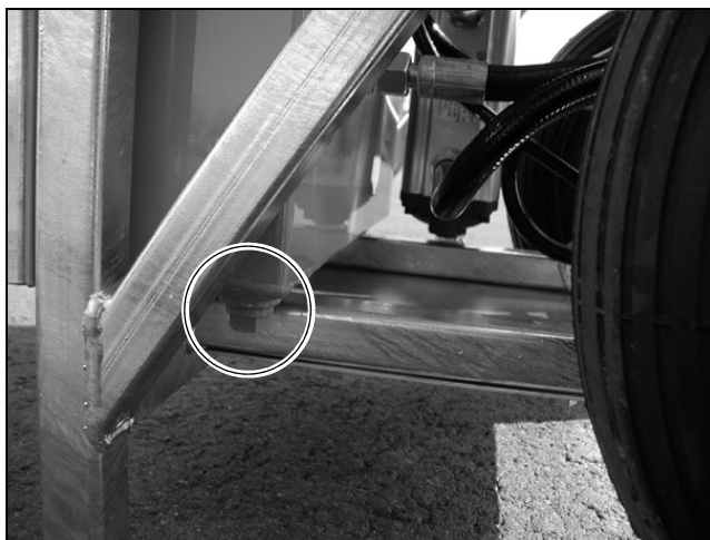
Рис. 6.2 Сливная пробка на баке HAG•12.20
