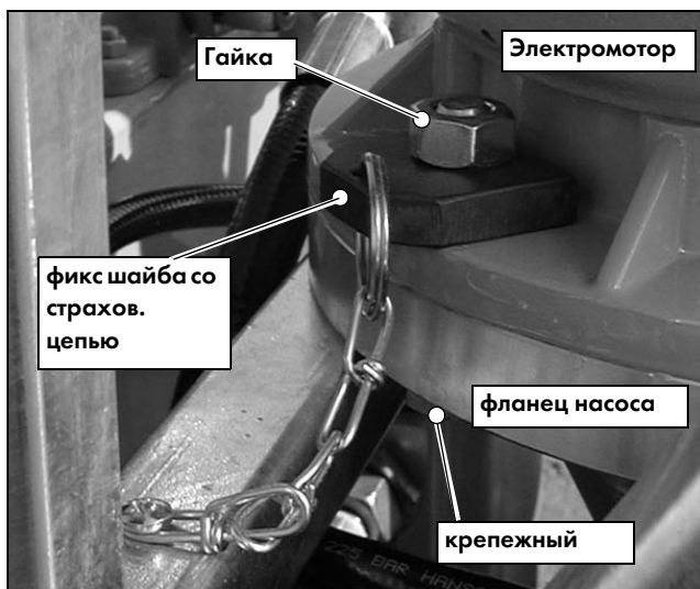
Рис. 7.2 Крепежный винт эл.мотора, HAG•12.20 слева
