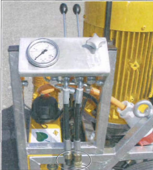
Рис. 5.38 Разъемы (возможно 2 блока управления) для гидравлической подачи CSA•1001 H (ниже) с пульта доп. маслостанции HAG•12.20
