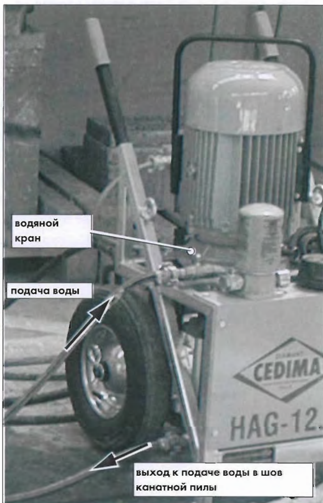
Рис. 5.16 Водяной разъем на малостанции, например HAG•12.10
