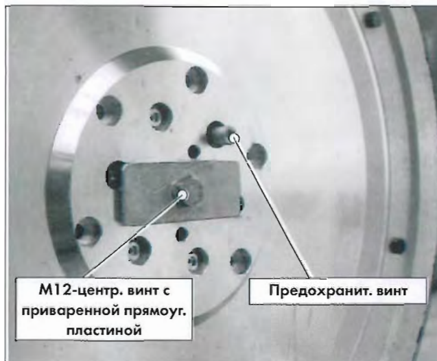
Рис. 5.4 Смонтированное приводное колесо с предохранительным винтом
