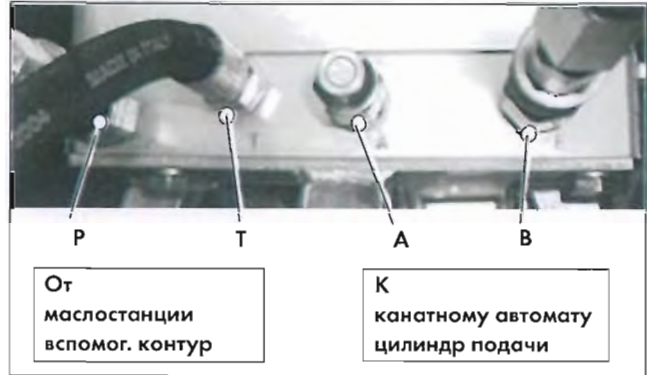
Рис. 5.22 Гидравл. пульт HSP•12 (Заказ-№ 48 85) вид сзади (разъемы)
