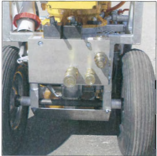
Рис. 5.40 Доп. маслостанция HAG•12.20, разъемы к двигателю привода каната, CSA•1001 H
