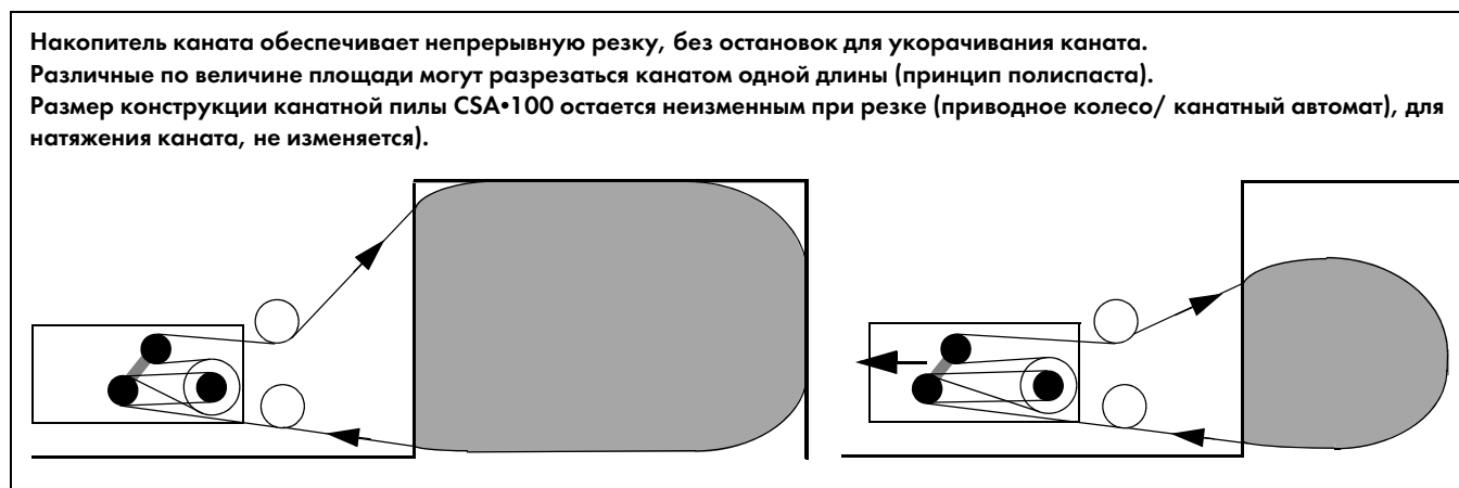
Рис. 1.3 Принцип работы CSA•100 (H) с накопителем каната (натяжение каната)
