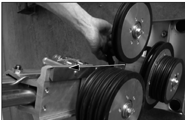
Рис. 5.13 Установка (заднего) пакета роликов на направляющие салазки
