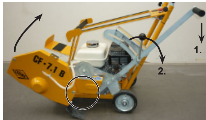
Кожух ремней, место контрольного отверстия Рис. 4.13
