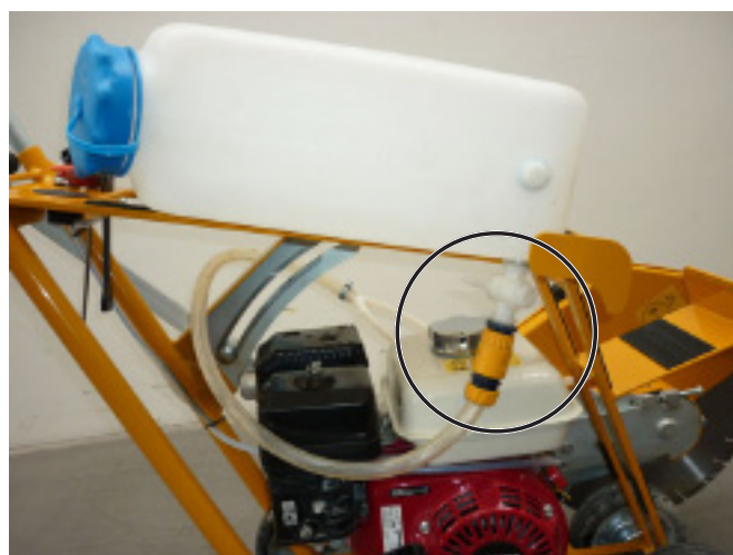
Водяной бак вставлен, муфта Гардена подключена к запорному и регулирующему крану Рис. 4.33
