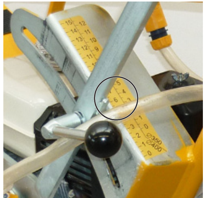
Указатель показывает на глубину 6 см для 400 мм и соотв. 3,5 см для алмазного диска 350 мм Рис. 4.28
