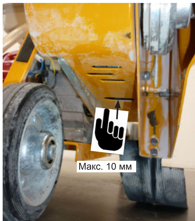
Контрольное отверстие для 3 клиновых ремней под защитным кожухом ремней Рис. 4.14
