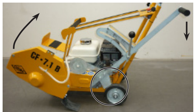
Рычаг заглабления с тормозной пластиной выравнен на режущем рукаве Рис. 4.5
