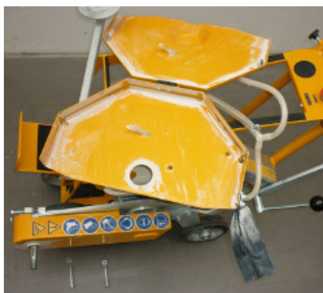
Кожух вместе с визирем положены на швонарезчик
