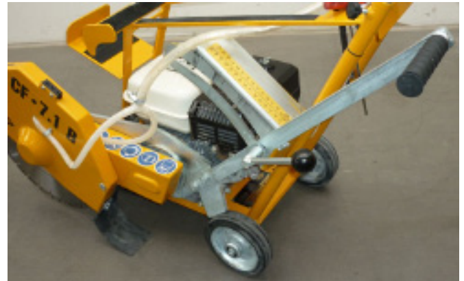
Алмазный диск поднят, указатель глубины резки на 0 Рис. 4.27
