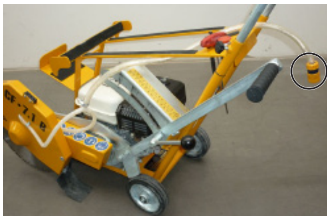
Соединительный шланг с муфтой Гардена для подключения от внешнего шланга источника воды Рис. 4.31
