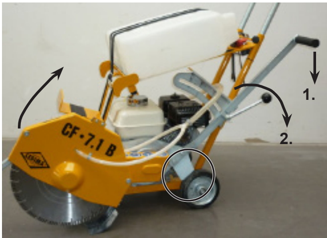
Режущий диск поднят, швонарезчик на стояночном тормозе благодаря тормозной пластине Рис. 4.37
