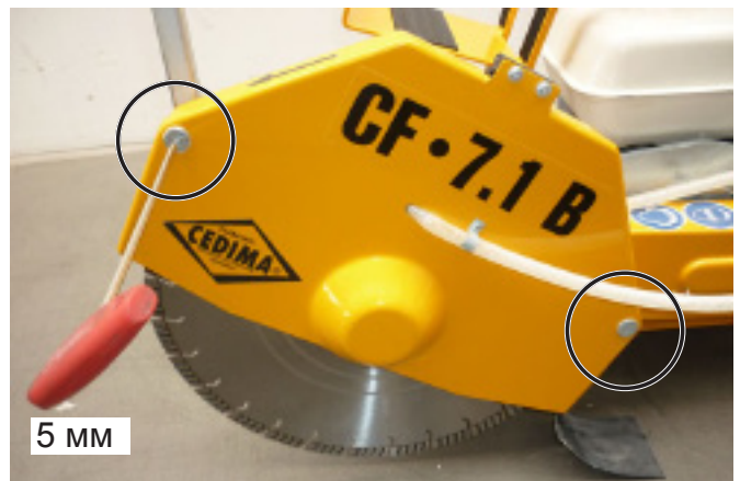
Алмазный диск смонтирован, защитный кожух закрыт
