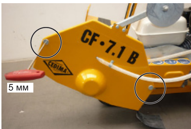
Отвинчивание круглых винтов на кожухе диска
