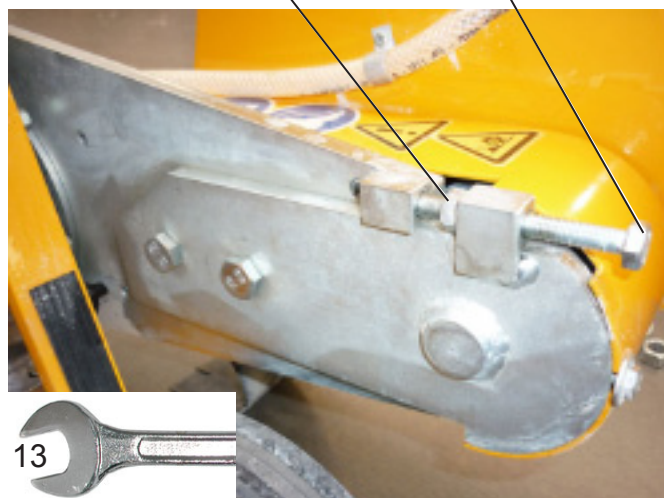
Контрагайка и винт натяжения ремней Рис. 6.2
