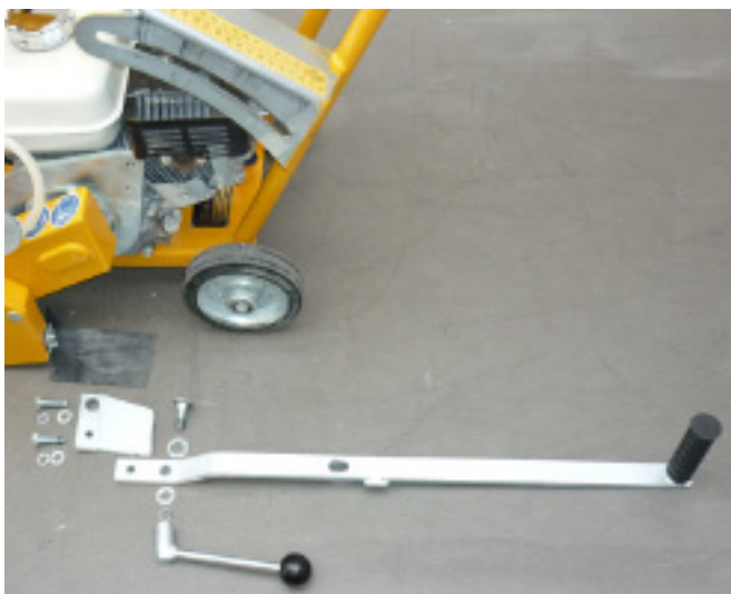
Тормозная пластина, рычаги заглабления и зажимной расположены с крепежными элементами
