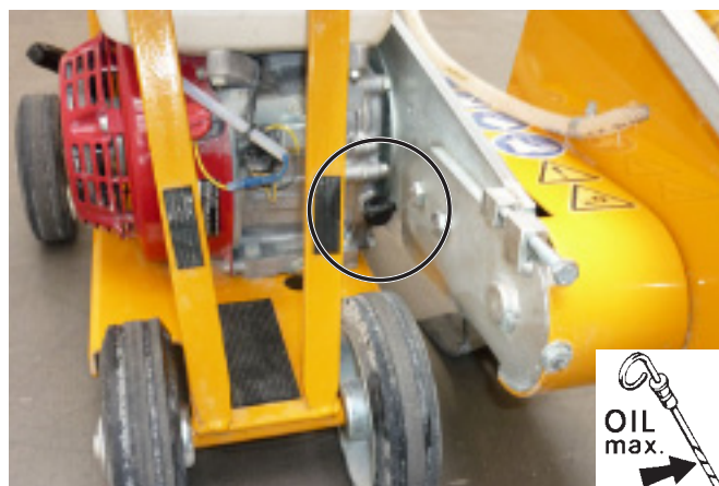
CF-7.1 B Спереди, масляный щуп, заливная пробка Bild 4.8
