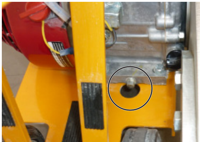
CF•7.1 В спереди, сливной винт моторного масла Рис. 6.8
