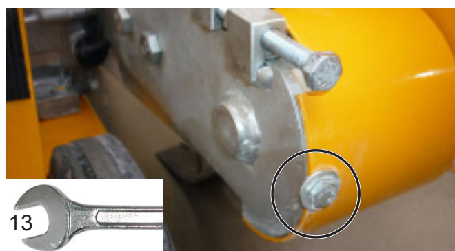
Ослабление переднего винта на кожухе ремней
