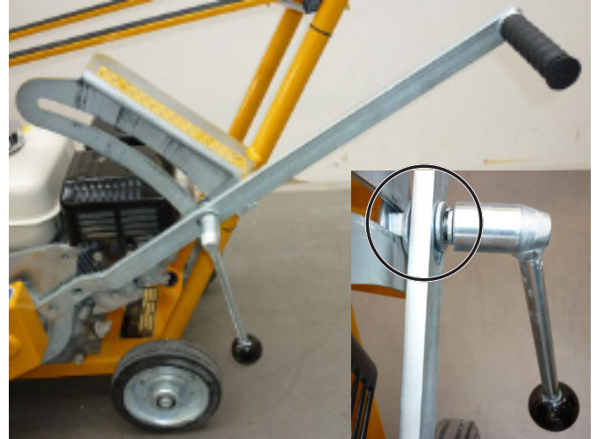
Смонтированы рычаги заглабления с зажимным Рис. 4.3
