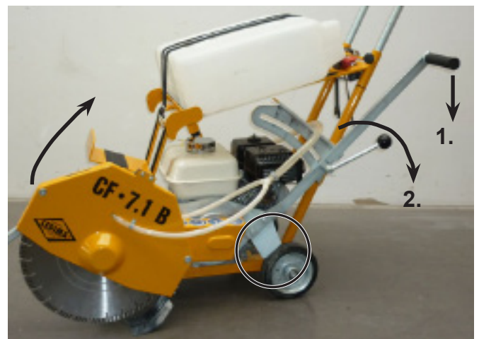
Режущий диск поднят, швонарезчик на стояночном тормозе благодаря тормозной пластине Рис. 4.41
