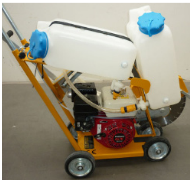
Смонтированы оба бака - основной и дополнительный, муфта Гардена подключена к запорному и регулируемому крану дополнительного бака
