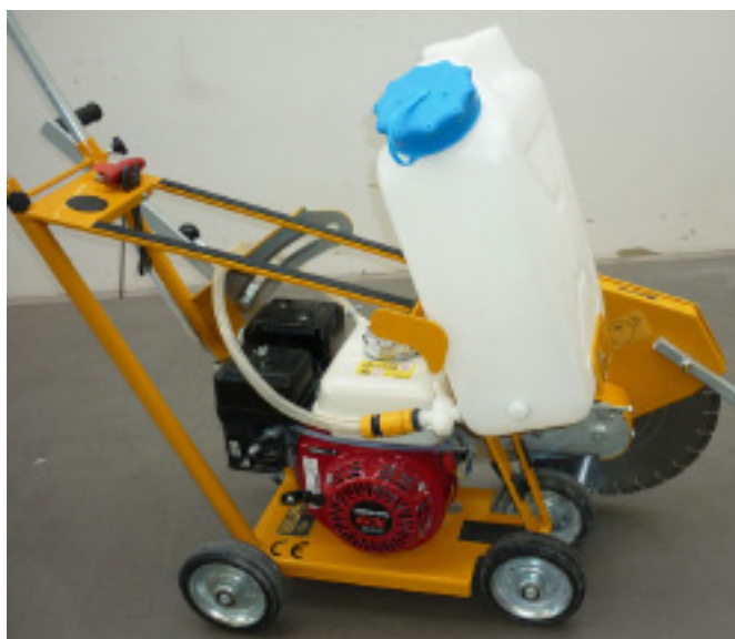
Водяной бак установлен на переднее крепление швонарезчика, муфта Гардена подключена к запорному и регулируемому крану
