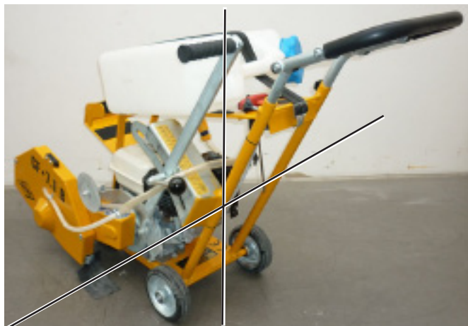
CF-7.1 B, Двигатель выровнен горизонтально Рис. 4.6
