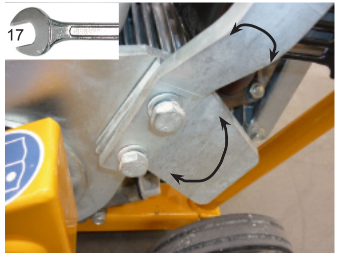
Рычаг заглабления смонтирован с тормозной пластиной на режущем рукаве Рис. 4.4
