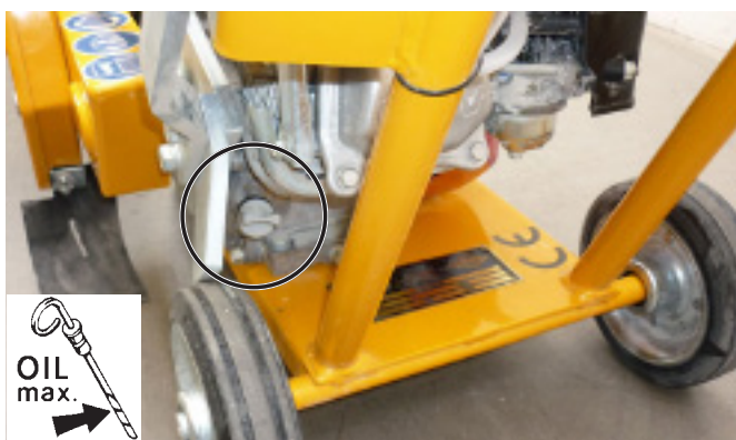
CF-7.1 B Сзади, масляный щуп, заливная пробка Рис. 4.7
