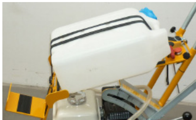
Водяной бак закреплен натяжным ремнем Рис. 4.34
