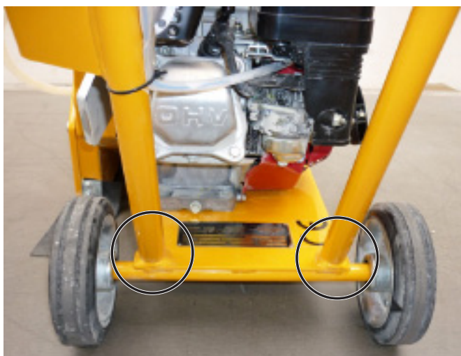
Места крепления на трубах подачи
