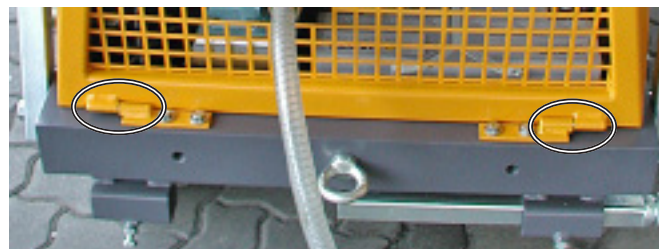
CF-6020 спереди, места смазки капота
