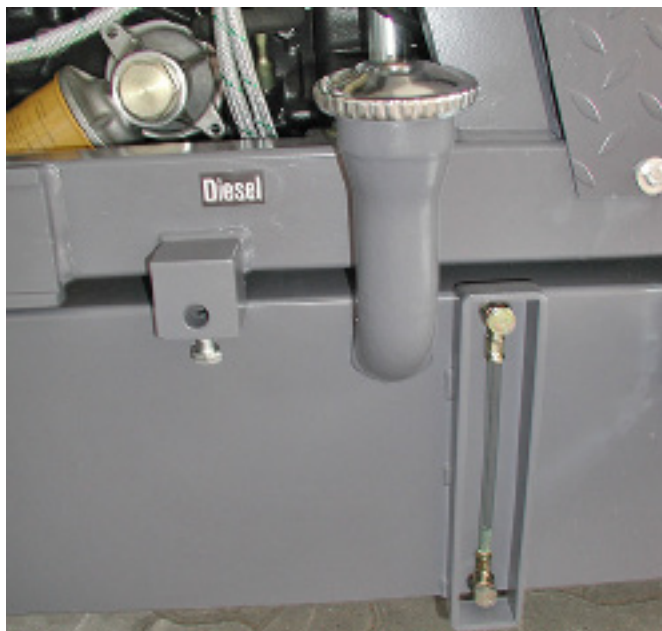
CF-6020 слева, заливная горловина для дизельного топлива и указатель уровня топлива в баке Рис. 5.2
