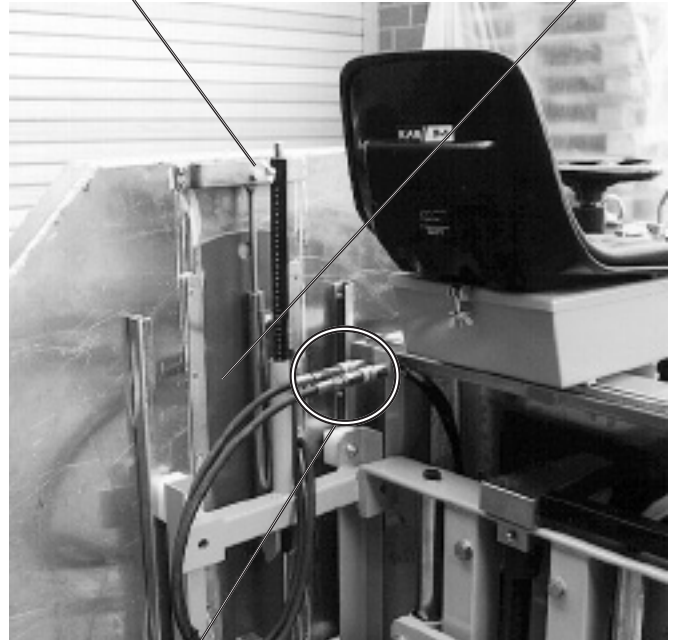
Гидрошланги для цилиндра подъема защитного кожуха Защитный кожух смонтирован слева
