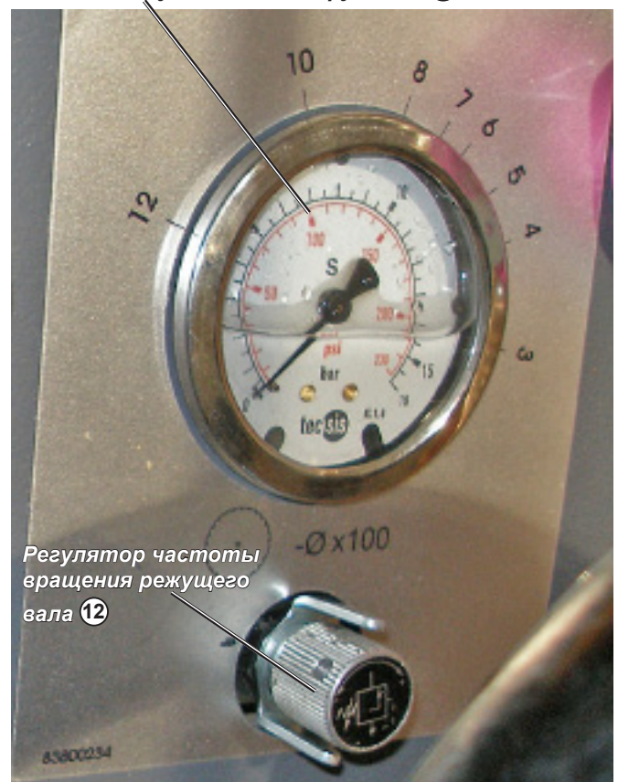
Органы управления для установки частоты вращения вала и соотв. диска согласно диаметра установленного диска
