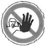
**Опасность травм! Швонарезчик SF•50.2E нужно выключить при чистке и при обслуживании/ремонте! Выключите двигатель привода диска! Отключите швонарезчик от электросети, вынув сетевой штекер! Защитите швонарезчик от случайного включения и скатывания!**
