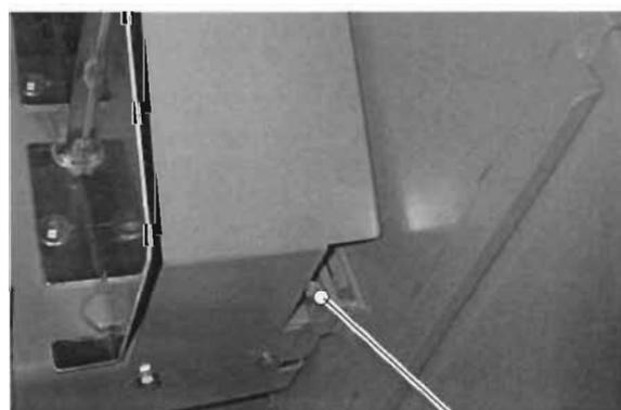
CF•50.2 E, зажимной винт кожуха диска (слева, спереди)
