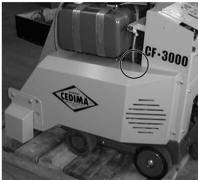
CF-3002D (слева) кожух ремней смонтирован (место для проверки натяжения ремня подачи) Рис. 4.16
