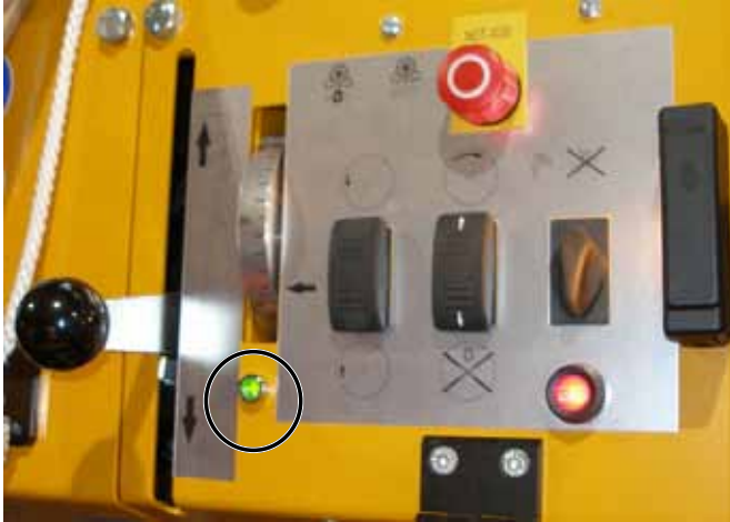
Рычаг подачи в среднем, нейтральном положении (контрольный индикатор горит)
