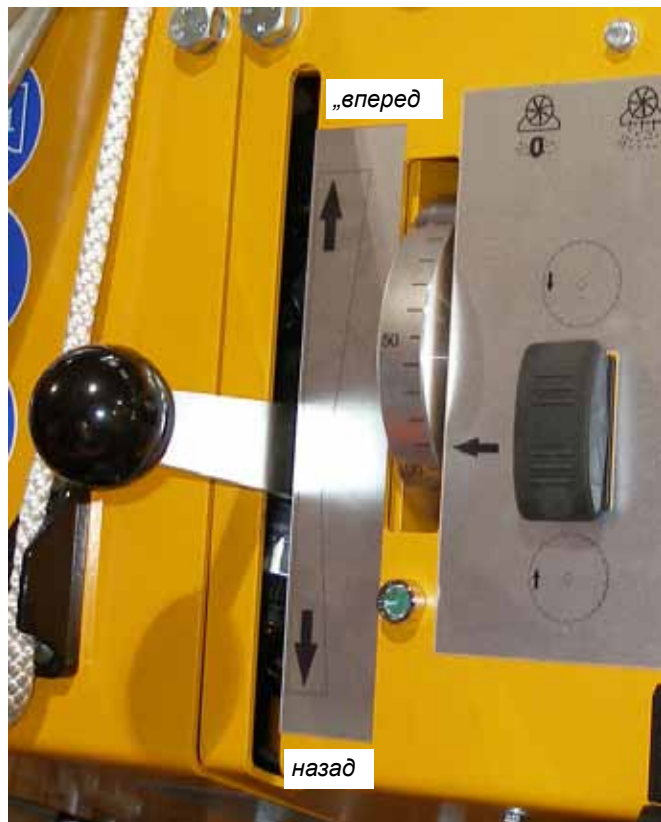
Рычаг подачи в среднем нейтр. положении
