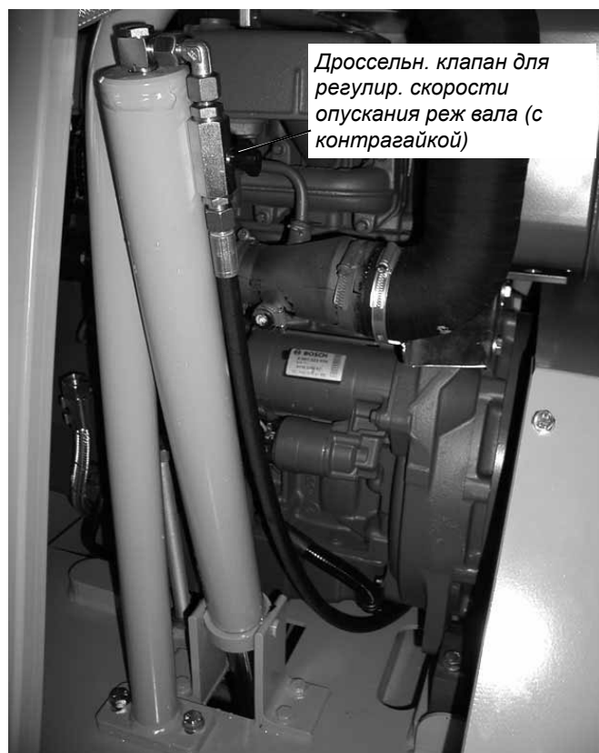
CF-3002 спереди, гидроцилиндр подъема опускания
