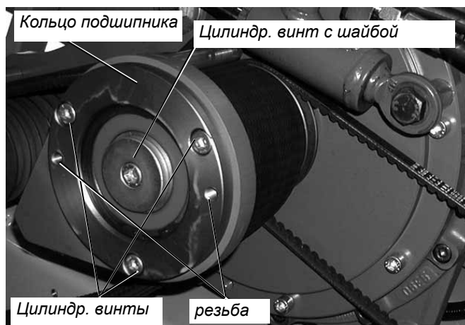
Шкив клинового ремня на двигателе, выступ. подшипник вала двигателя
