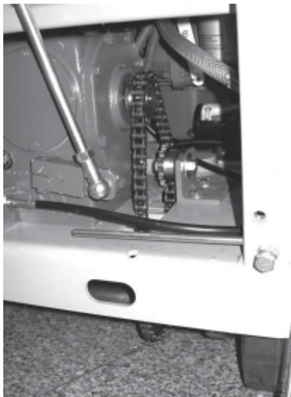
CF•2500 D, цепной привод подачи, задняя защитная пластина снята
