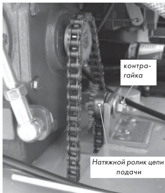
CF•2500 D, Цепь привода подачи, задняя крышка снята
