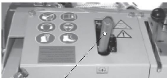
Рычаг управления подъема режущего вала
