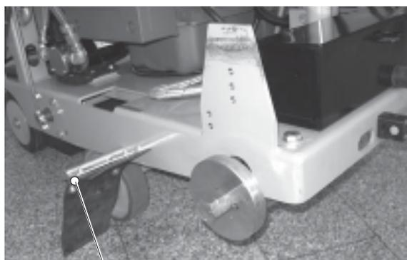
CF•2500 D свежий бетон, кожух диска справа снят
