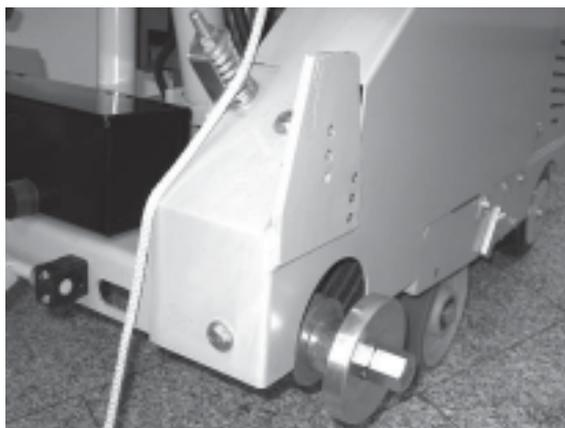
CF•2500 D свежий бетон, кожух вала (слева) снят
