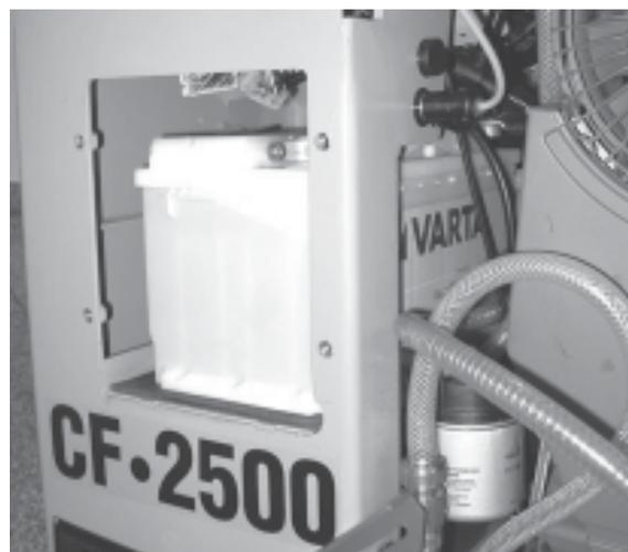
CF•2500 D справа, кожух аккумулятора снят
