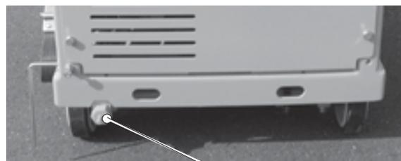
Гайка поднастройки оси
