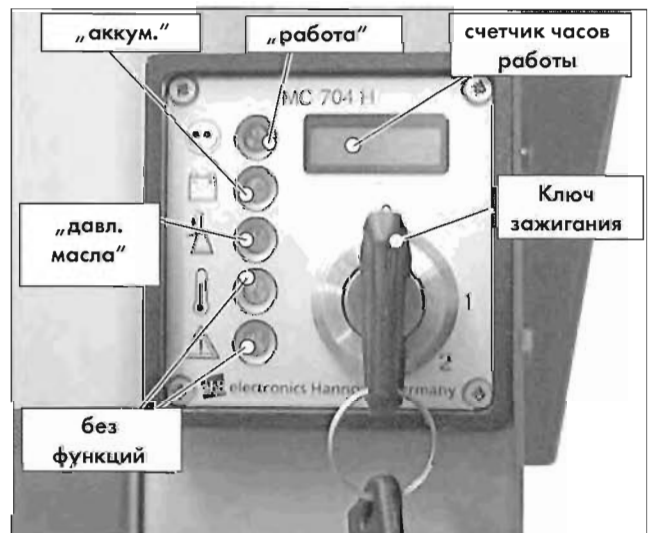
Рис. 4.10 Блок управл. двиг. со счетчиком часов работы
