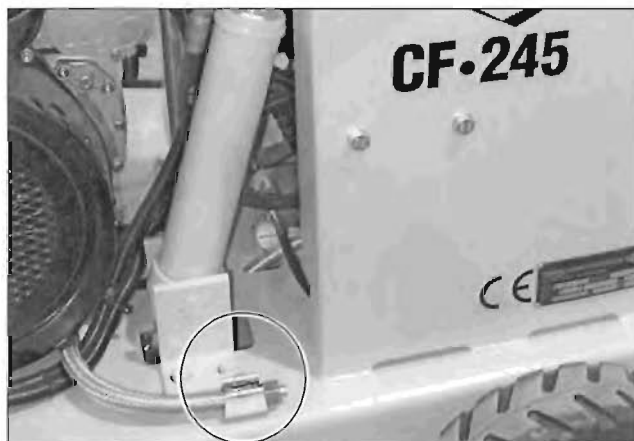
Рис. 6.29 CF•245 D слева, сливной шланг моторного масла с винтовым замком в держателе
