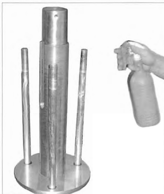
Рис. 4.37 Нанесение смазки противокоррозионной защиты на фрезерный вал, тяги...
