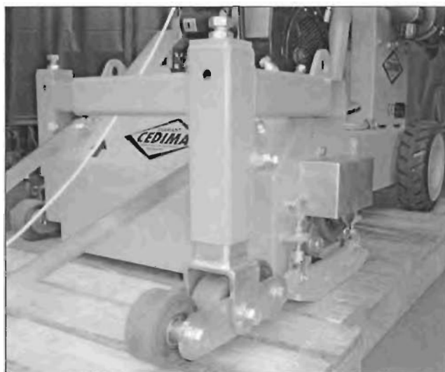
Рис. 4.18 Левый блок опорных роликов смонтирован перед фрезерным валом
