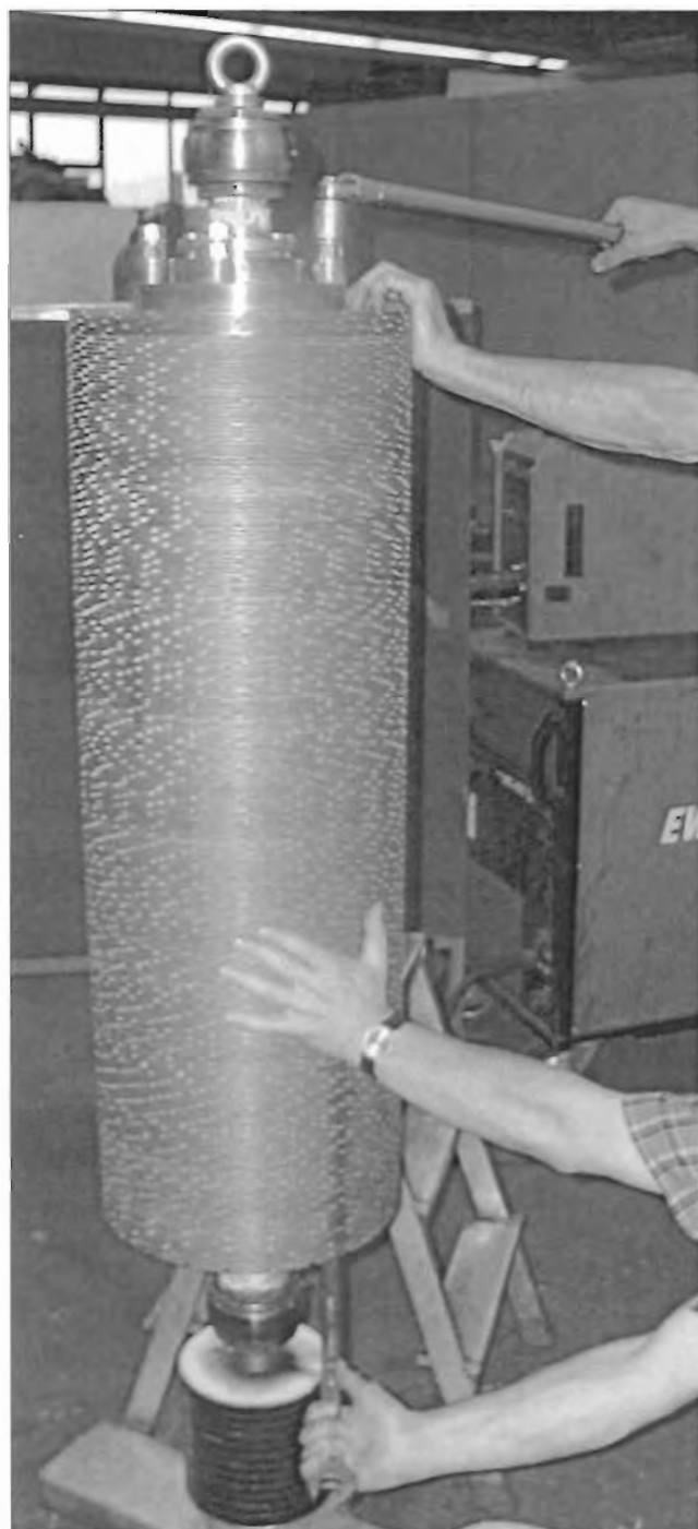
Рис. 4.43 Затягивание гаек (контрагаек) с помощью ключа с динамометром (130 Нм) со стороны съемного подшипника (сверху) на аналогичном фрезерном валу
