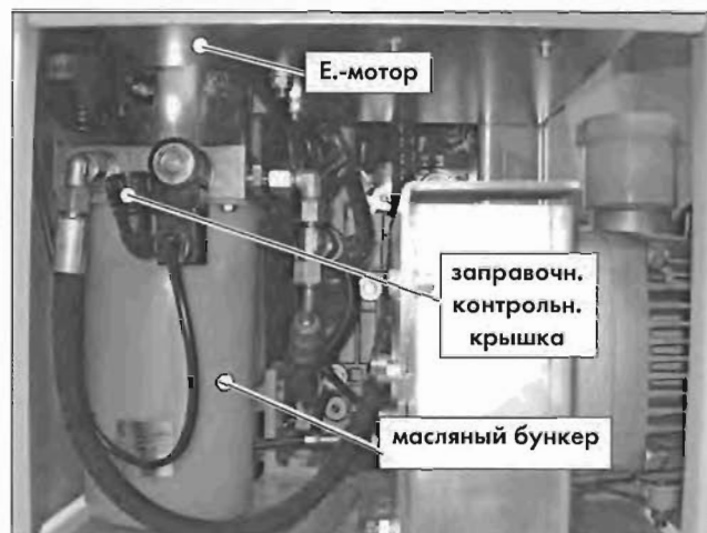
Рис. 6.13 Электрогидравлическая компактная маслостанция
