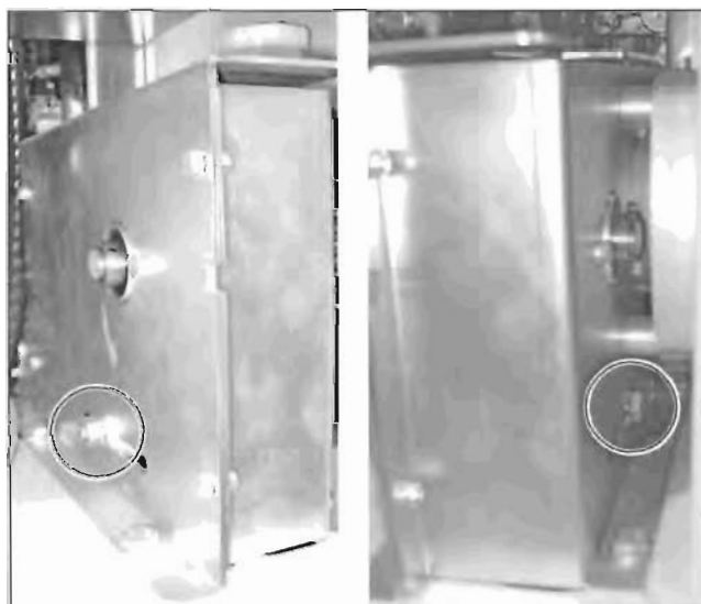
Рис. 6.17 Корпус привода подачи, вид на левую и правую гайку натяжного колеса цепи
