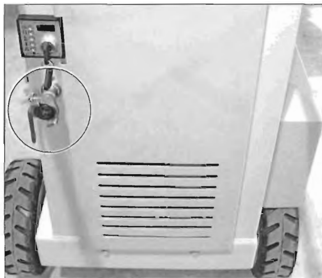
Рис. 4.48 Разъем внешнего источника, запорный кран (шаровый кран) с Гека муфтой
