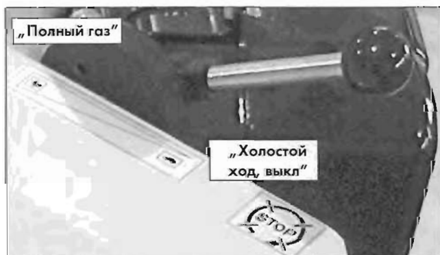
Рис. 4.12 Рычаг частоты вращения двигателя (в положении малой частоты вращения, ВЫКЛ/Стоп)
