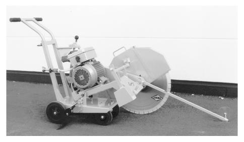
Особенностью данной модели швонарезчика является легко разборная конструкция, которая разбирается на три части, причем самая тяжелая часть весит 60 кг и может переноситься двумя рабочими.
