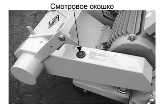
В защитном кожухе имеется смотровое окно для ухода и проверки натяжения клинового ремня. При этом не требуется снимать защитный кожух.
