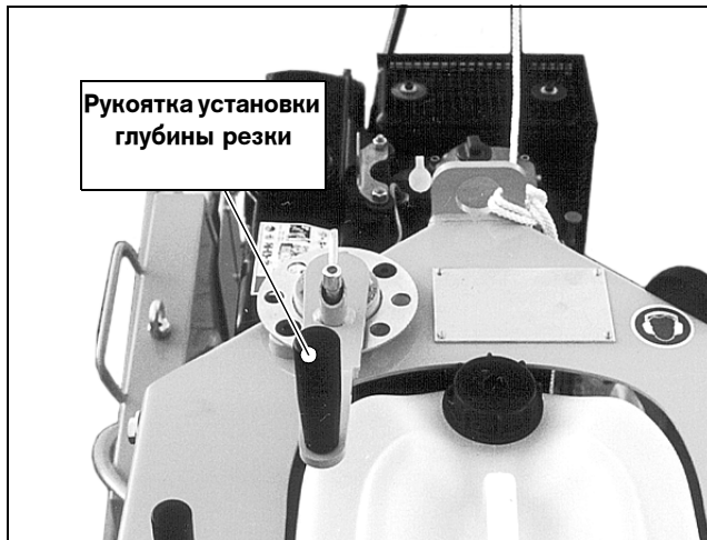
Рис. 4.10 Ручная установка глубины резки
