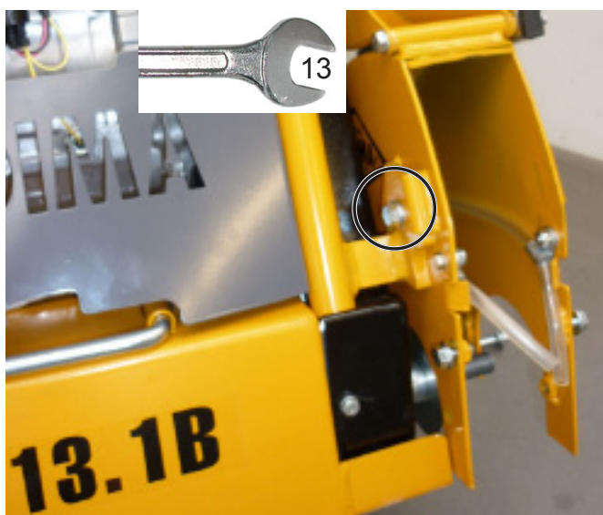
Затягивание винта на держателе кожуха диска
