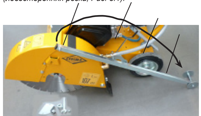
Левосторонняя резка, не откидывайте визирь назад Рис. 5.1
