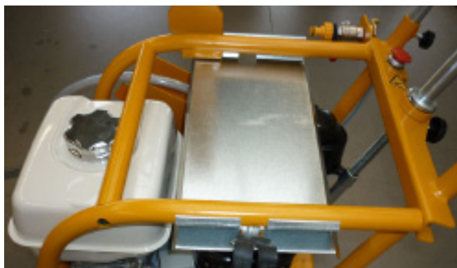
Теплозащитная пластина, водяной бак снят
