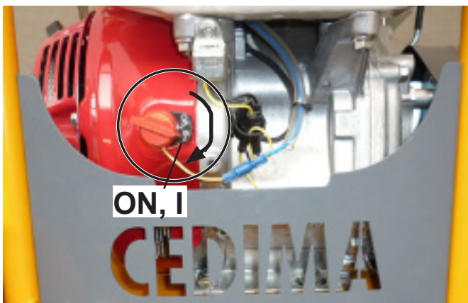
CF•13.1 В спереди, включите зажигание двигателя Рис. 4.66
