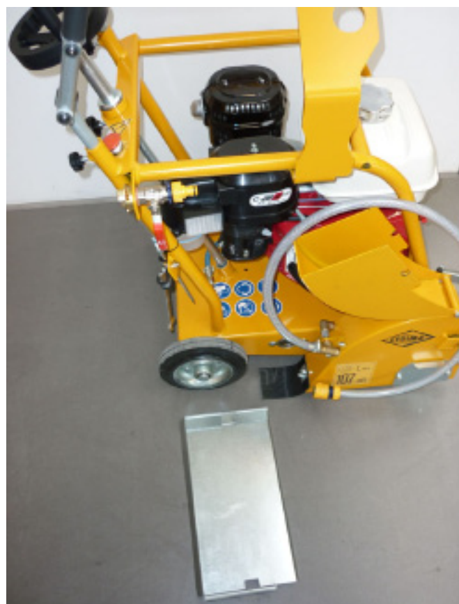
Теплозащитная пластина, водяной бак снят
