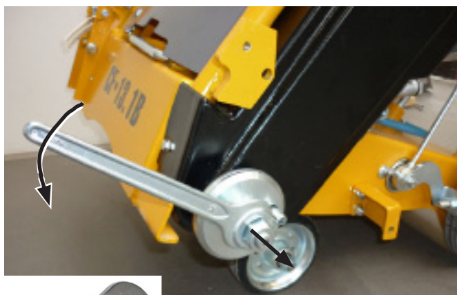
Отвинтите гайку режущего вала с правой резьбой Рис. 4.32
