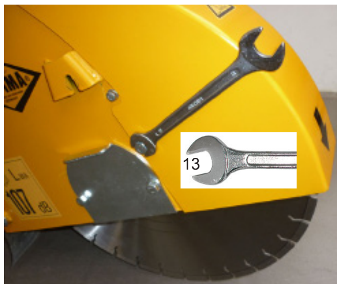
Закрыт колпак защитного кожуха диска
