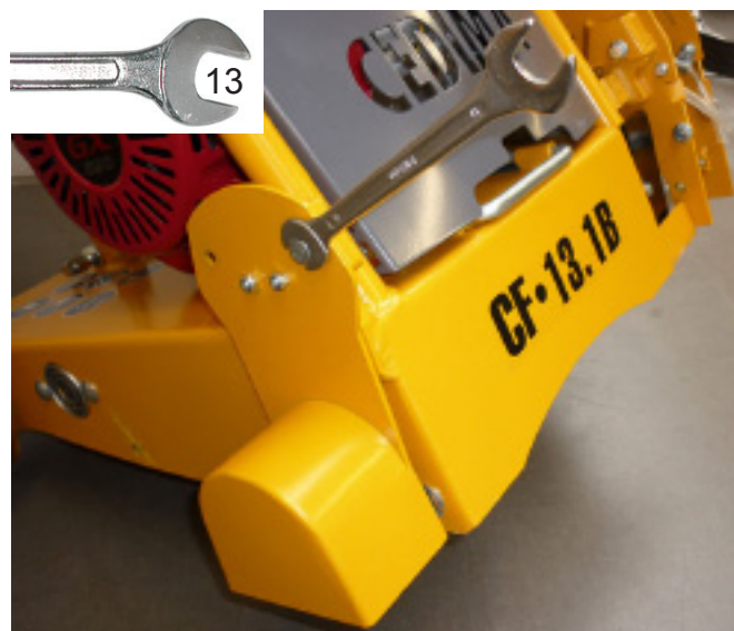
Кожух режущего вала смонтирован справа Рис. 4.50
