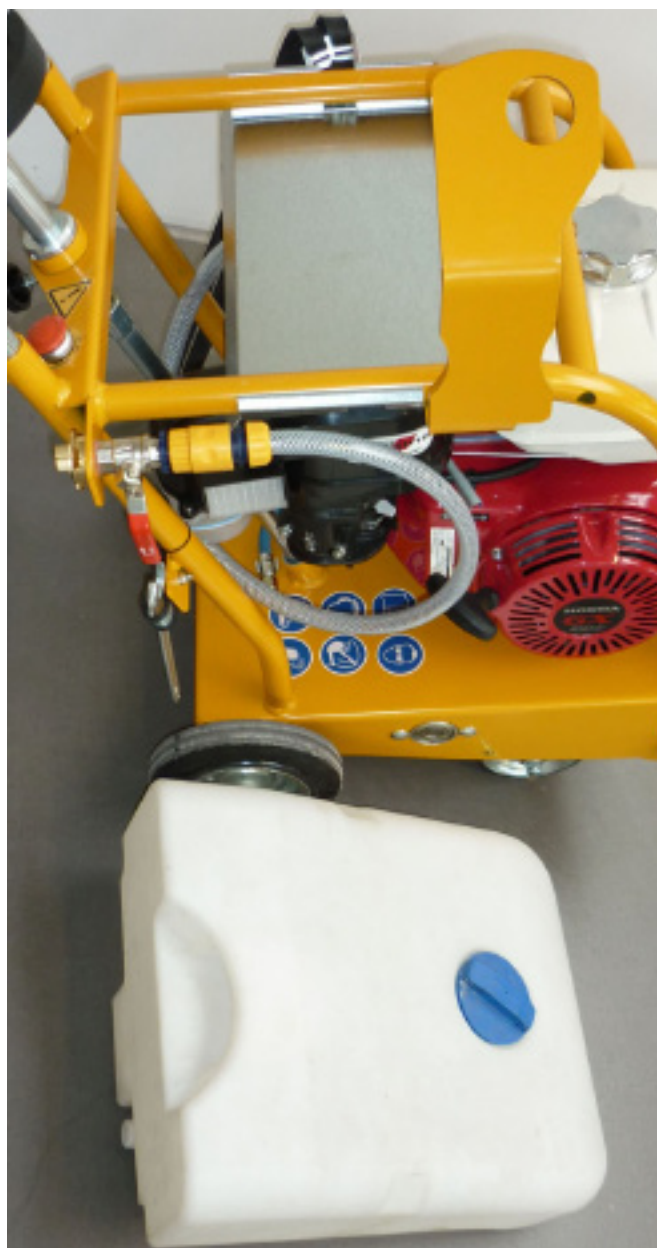
Водяной бак снят Рис. 4.58
