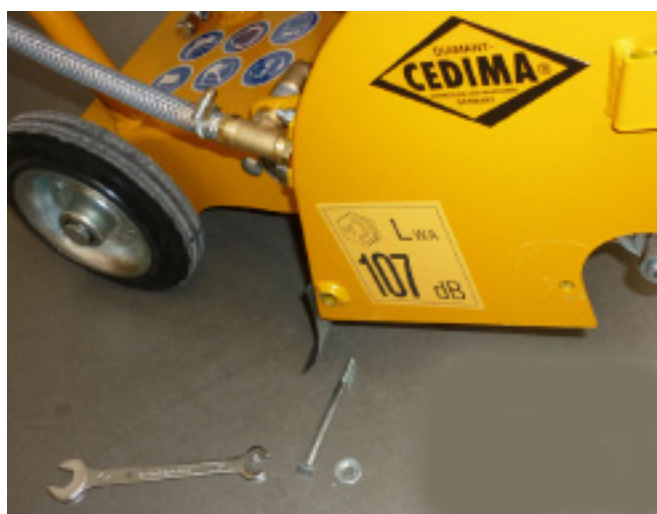
Винт с шайбой снят с кожуха диска Рис. 4.36
