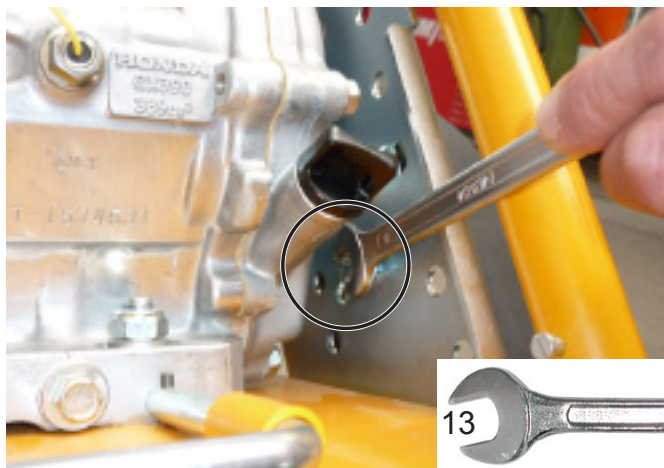
3. Зажимной винт натяжителя клинового ремня Рис. 6.1
