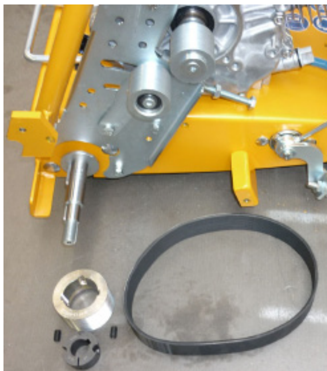
11. Завинчивайте шпильку в третье отверстие и, тем самым, шпилькой будет выдавливаться коническая зажимная втулка из шкива клинового ремня Рис. 6.11
