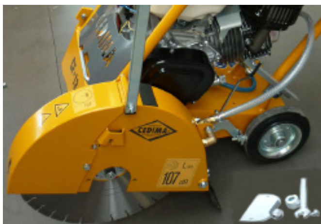
Водяной бак подключен для левосторонней резки Рис. 4.63
