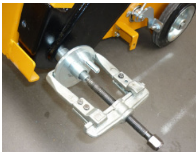
5. Снятие фланца крепления диска с левой стороны режущего вала Рис. 6.5
