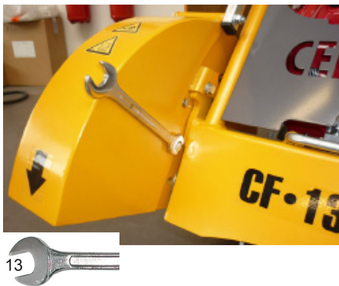
Левый зажимной винт колпака защитного кожуха
