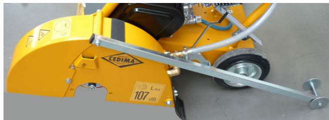
CF•13.1 В кожух диска слева, передний визирь откинут назад
