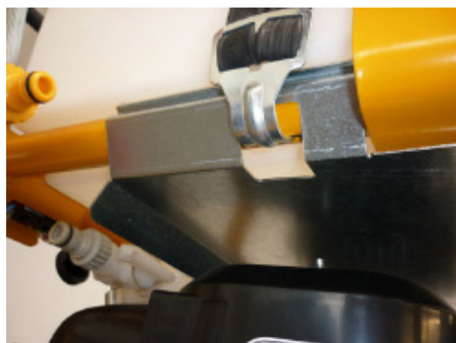
Закрепление водяного бака резиновым ремнем справа на раме шварцрезчика
