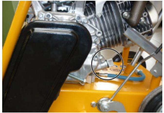
CF•13.1 В слева, задний масляный щуп, заливная горловина Рис. 4.2
