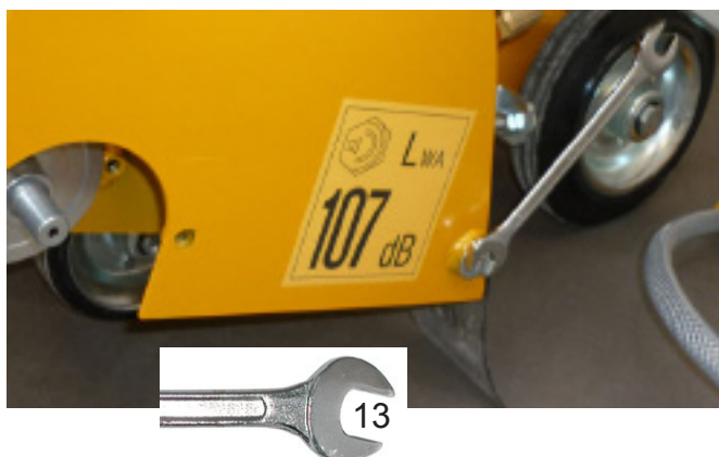
Кожух диска закреплен с помощью винта (с шайбой)
