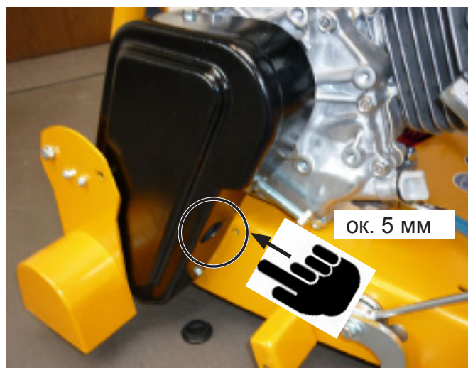
Вынута заглушка из кожуха клинового ремня, проверка клинового ремня через отверстие
