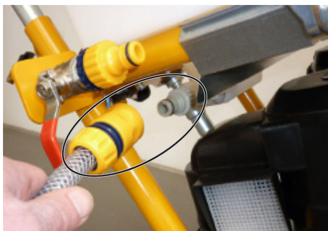
Соединительный шланг с муфтой гардена подсоединен к регулировочному/запорному крану на водяном баке
