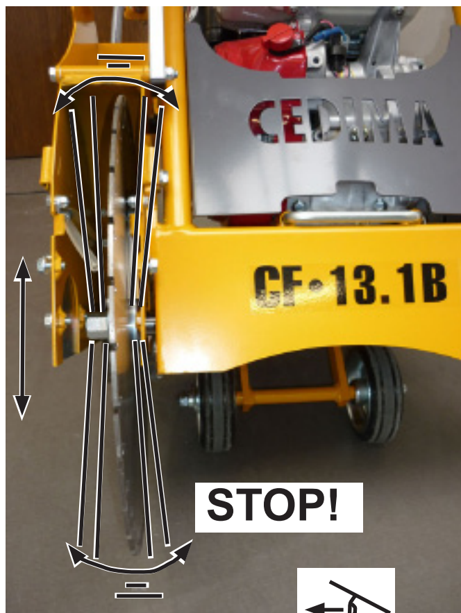
Снимите защитный кожух вала (левый)
