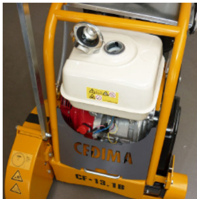
Водяной бак снят и открыта топливная заливная горловина
