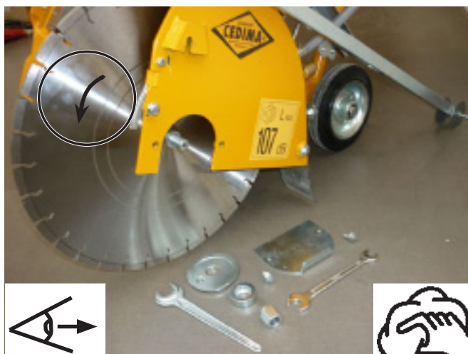
Вставьте алмазный диск с правильным направлением на левую сторону вала, в поводковый штифт
