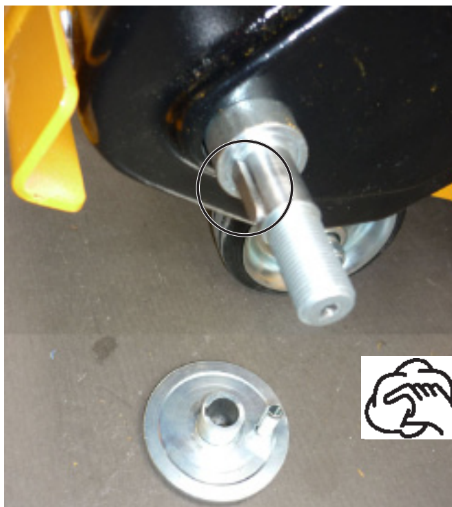
6. Фланец крепления диска с левой стороны вала снят, призматическая шпонка Рис. 6.6
