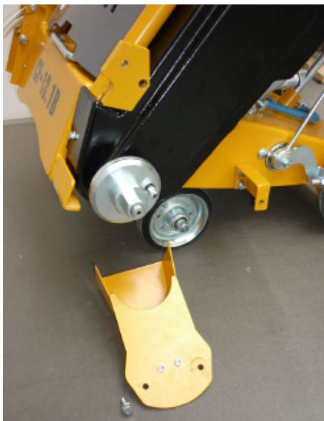
Защитный кожух режущего вала снят
