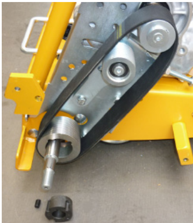
12. Коническая зажимная втулка вынута из шкива клинового ремня на режущем валу Рис. 6.12
