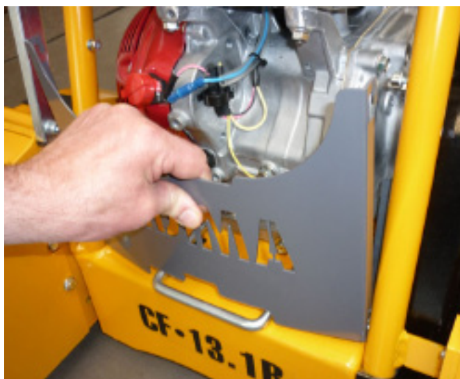
Снятие передней пластины
