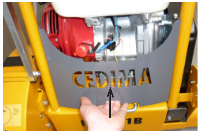
Снятие передней пластины из крепления Рис. 4.4
