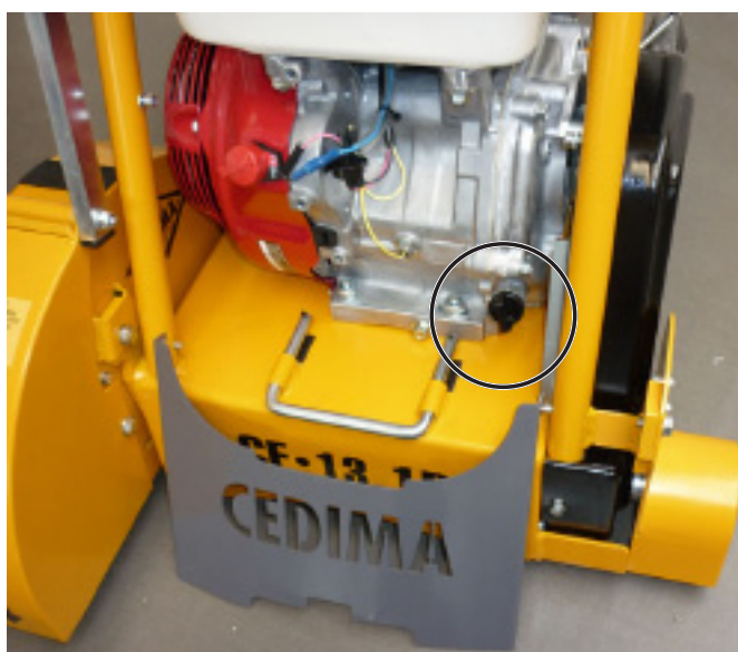
Передняя заливная горловина/ щуп (передняя пластина снята)
