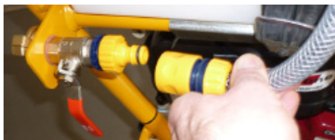
Подсоедините водяной разъем к кожуху диска (см. п. 4.10)
