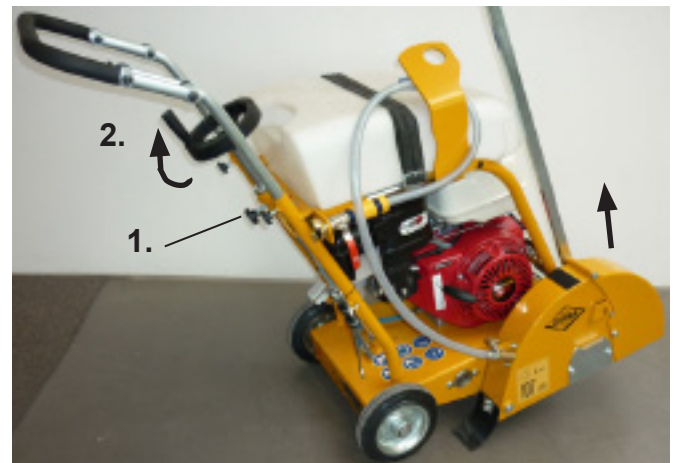
Поднимите режущий вал
