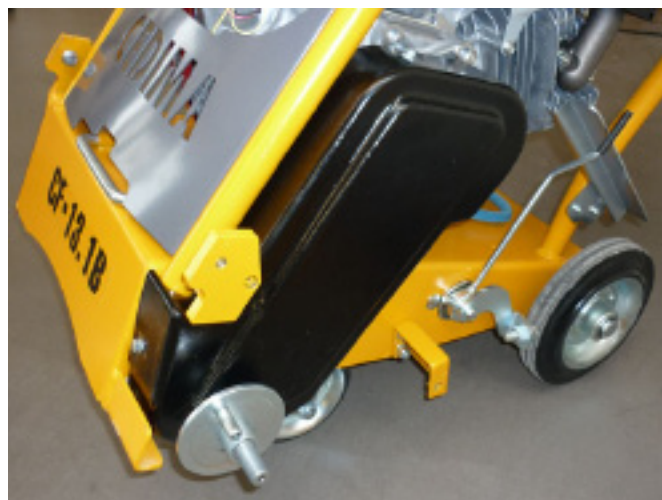
4. Левая сторона вала, снимите кожух диска и при необх. диск, гайку вала, прижимное кольцо, прижимной фланец, и соотв. защитный кожух вала Рис. 6.4
