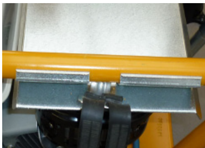
Водяной бак с резиновым ремнем закреплен на левой стороне шварцрезчика
