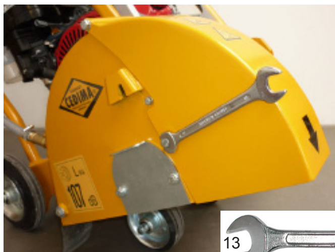
Правый зажимной винт колпака защитного кожуха
