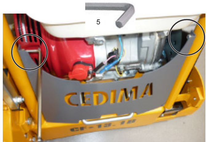
Отвинчивание винтов на передней пластине Рис. 4.3
