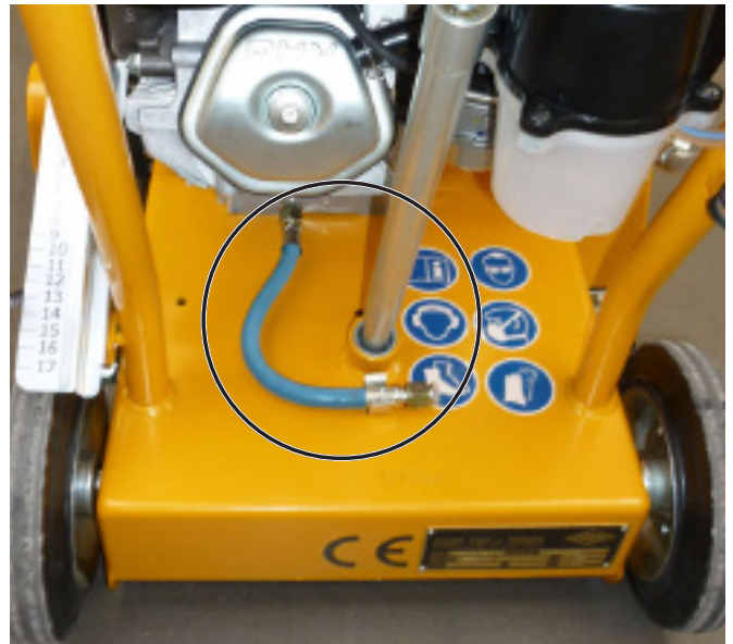
Сливной шланг моторного масла в держателе Рис. 6.23
