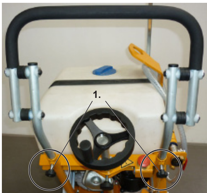
Скоба подачи смонтирована в поз. 1
