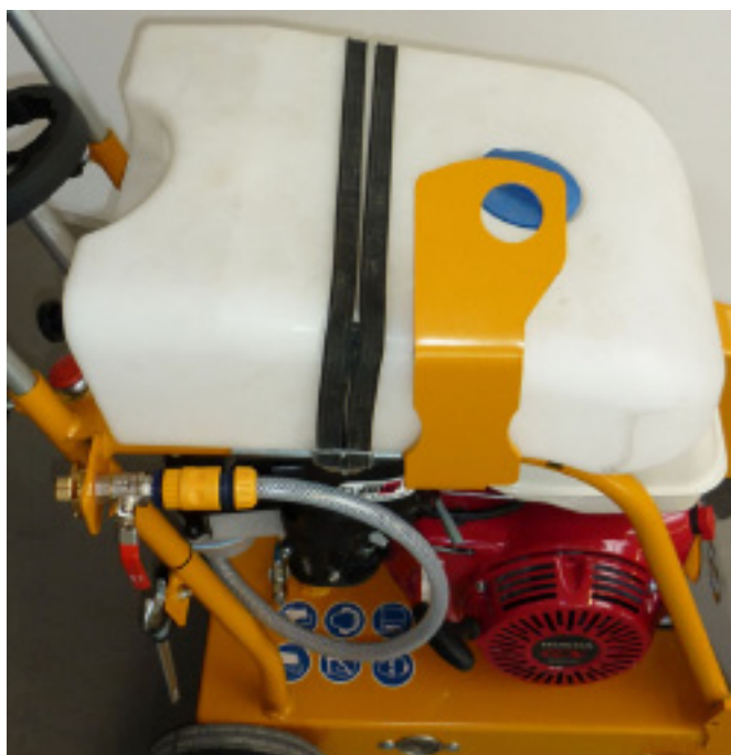
Водяной бак смонтирован
