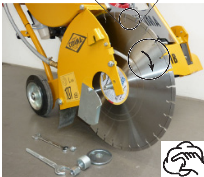
Надет алмазный диск с правильным направлением вращения с правой стороны вала, в поводковый штифт Рис. 4.22
