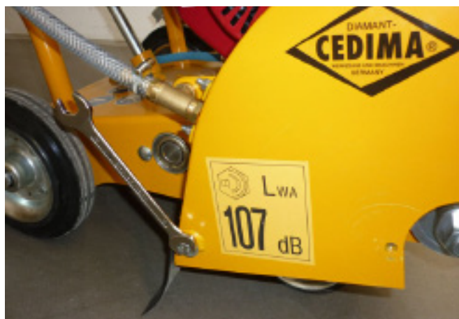
Снимите защитную пластину с кожуха диска Рис. 4.34
