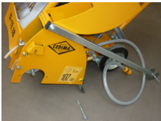
Подготовлен винт с шайбой к монтажу кожуха диска
