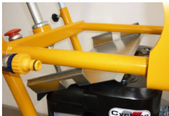
Теплозащитная пластина выдвинута из рамы
