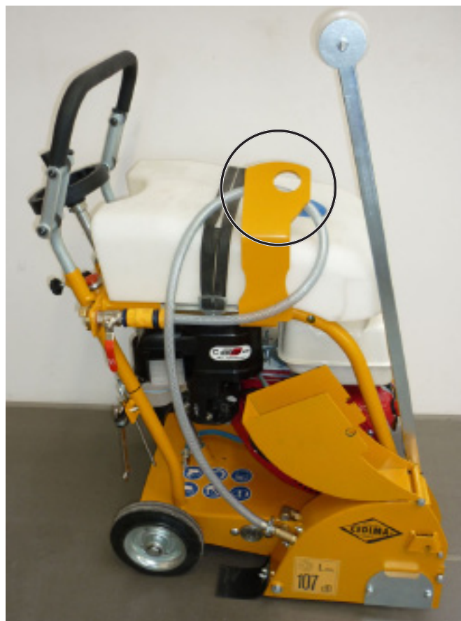
CF•13.1 В Кожух диска справа, в транспортном положении, рым-болт
