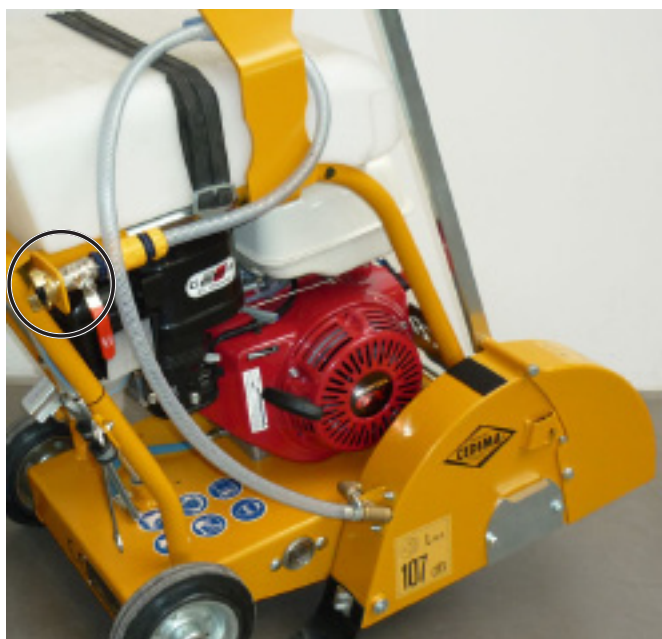
Разъем к внешнему источнику воды, шланг подключен для правосторонней резки Рис. 4.57
