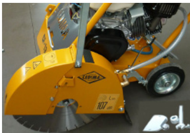
Соединительный шланг с муфтой Гардена подключен к крану внешнего источника воды, шланг подключен для левосторонней резки
