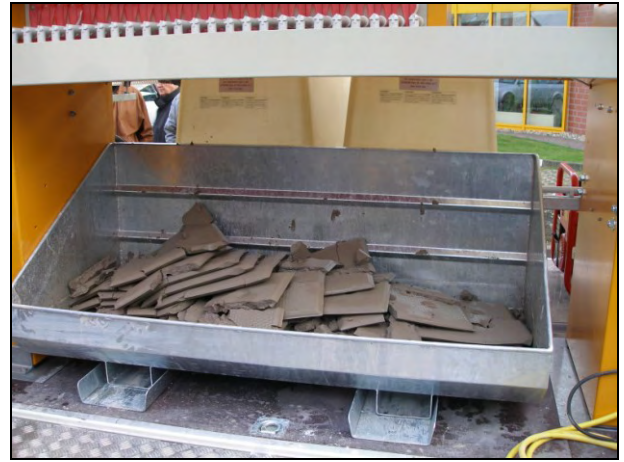
Рис. 3.7: Емкость для твердых отходов с спрессованным бетонным шламом
