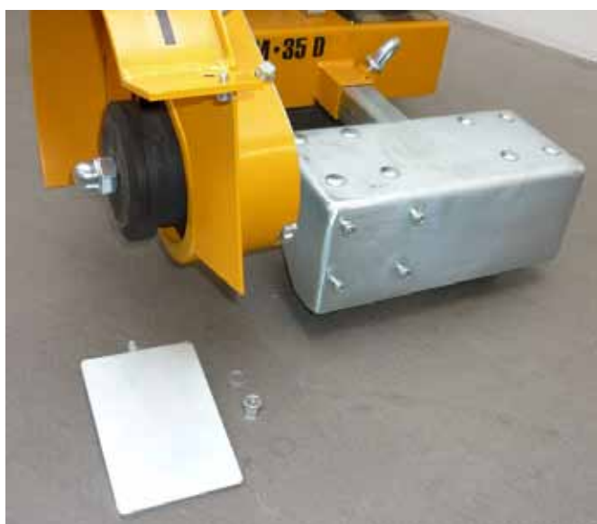
Щиток снят (гайка, шайба)
