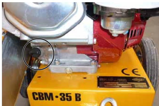
СВМ•35 В спереди, масляный щуп, заливная горловина
