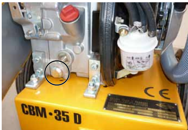
СВМ-35 D, Передний сливной винт моторного масла Рис. 6.10
