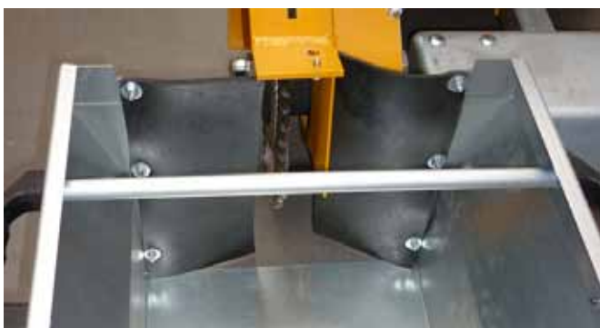
Выравнивание уплотнительных резинок Рис. 4.41
