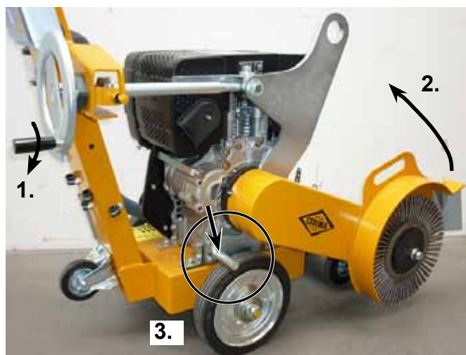
Приводной вал, щетка поднята, щеточная машина на стояночном тормозе
