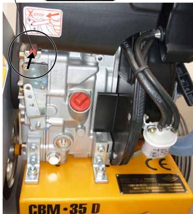
СВМ•35 D спереди, нажмите на стопорный штифт (до остановки двигателя)
