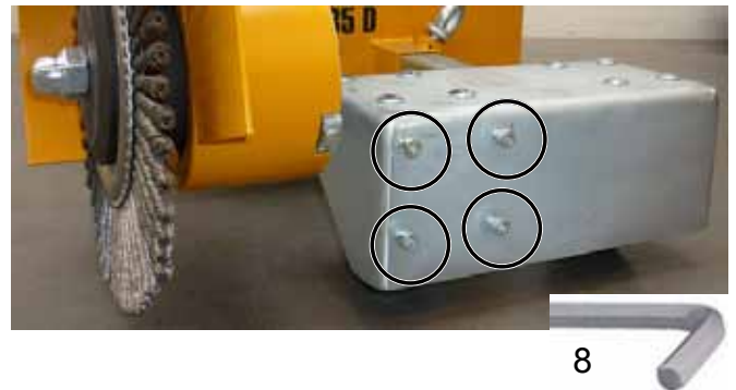
Отвинтите 4 винта в комплекте колес
