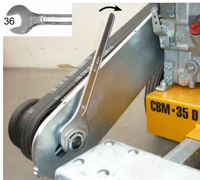
Затягивание гайки опоры щеточного вала Рис. 6.3
