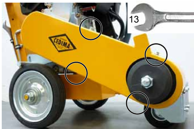
Винты кожуха клиновых ремней (с шайбами) Рис. 4.13
