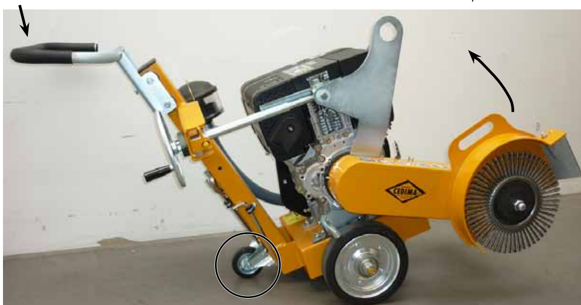
Щетка поднята путем наклона щеточной машины
