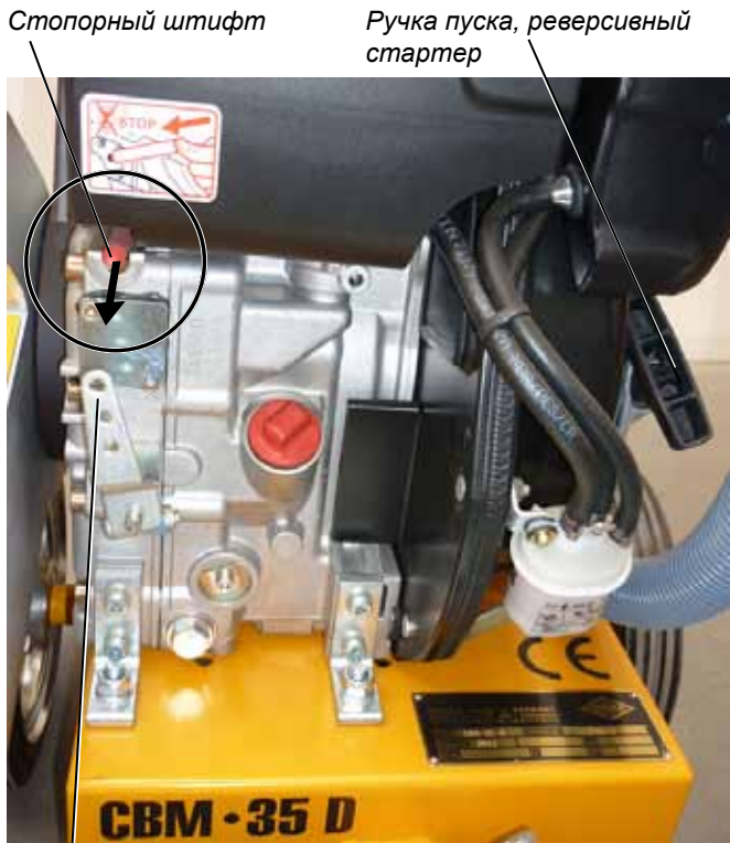
СВМ-35 В слева, органы управления двигателем Рис. 4.49
