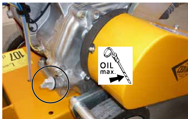
СВМ•35 В сзади, масляный щуп, заливная горловина
