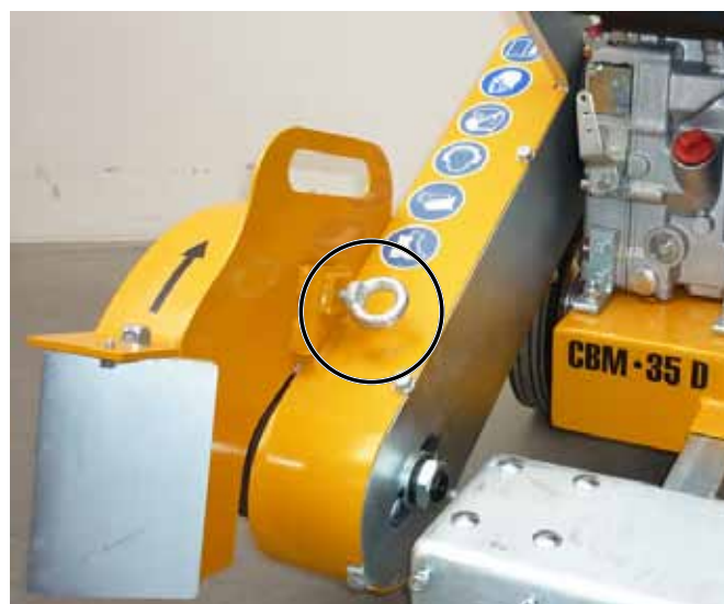
Прижимной винт кожуха щетки
