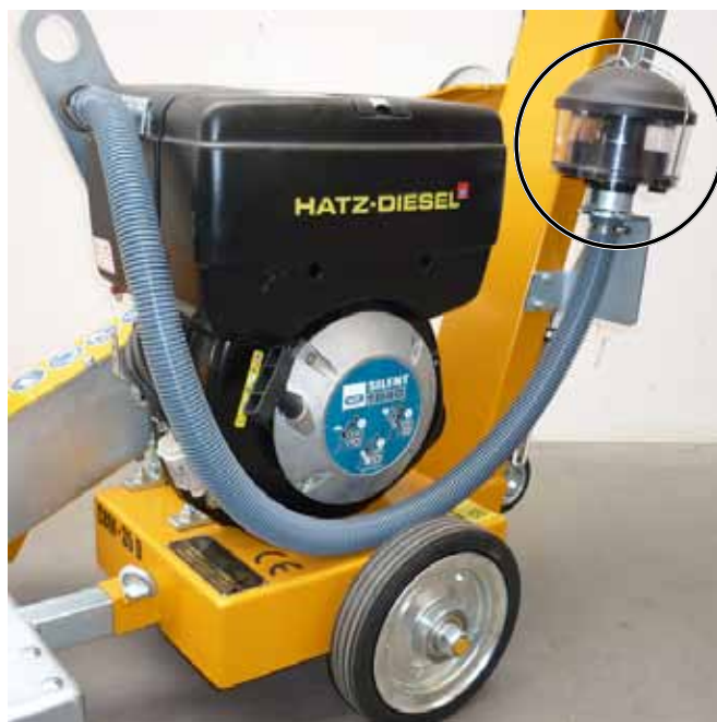
СВМ-35 D, Циклонный воздушный фильтр
