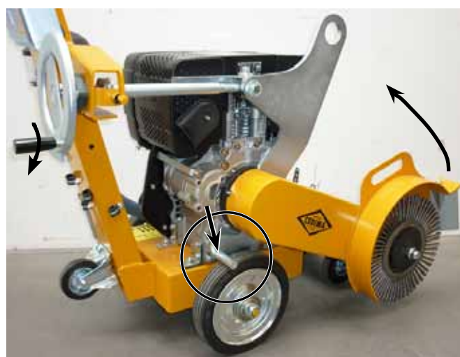
Вал щетки, щетка поднята, щеточная машина встала на стояночный тормоз Рис. 4.17
