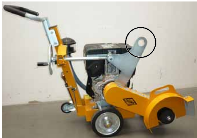
СВМ•35 D в положении транспортировки и хранения, крановая проушина
