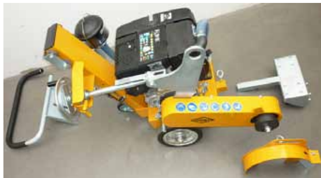
Рукоятка, передний комплект колес и кожух щетки сняты
