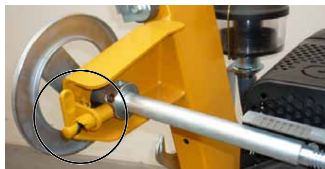
Стопор установки глубины прочистки (маховик, шпиндель)
