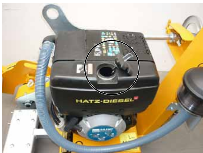
СВМ•35 D топливный бак с горловиной (открыта) Рис. 4.6
