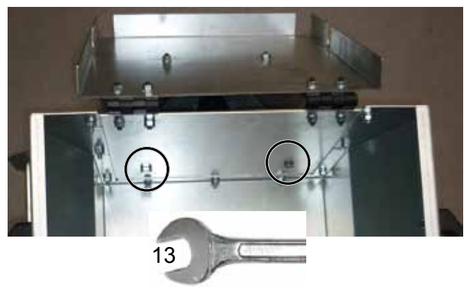
Регулировка клиренса передним колесом Рис. 4.43
