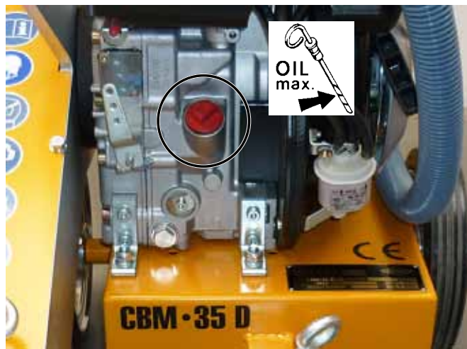
СВМ•35 D спереди, масляный щуп, заливная горловина
