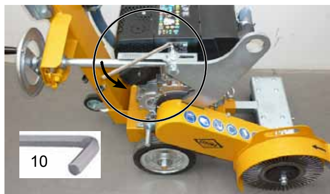
Ослабить прижимной винт на указателе
