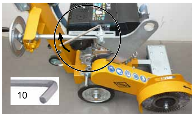
Затяните зажимной винт на указателе
