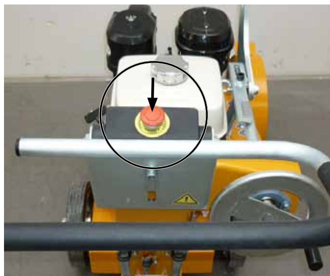
СВМ•35 В, Нажмите на аварийную кнопку (кнопка должна защелкнуться)
