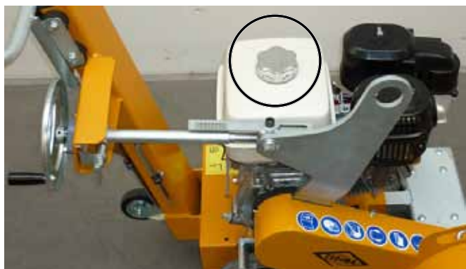
СВМ•35 В топливный бак с заливной горловиной Рис. 4.5
