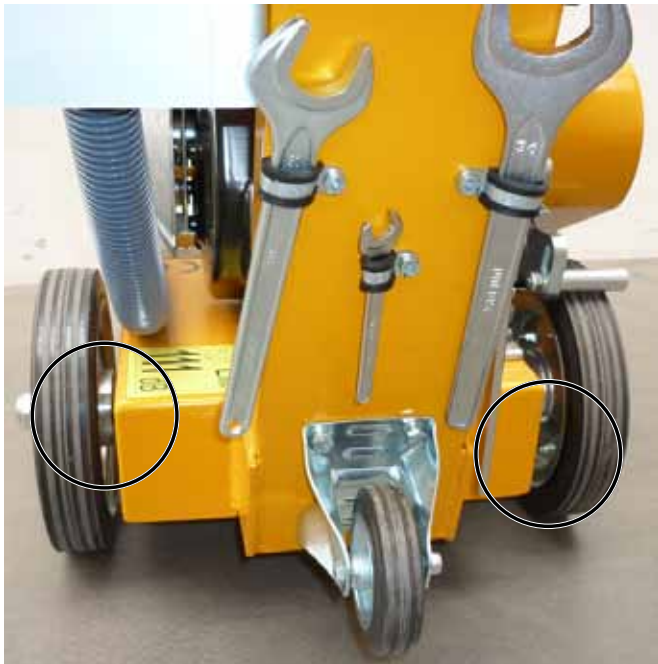
Места крепления на осях колес
