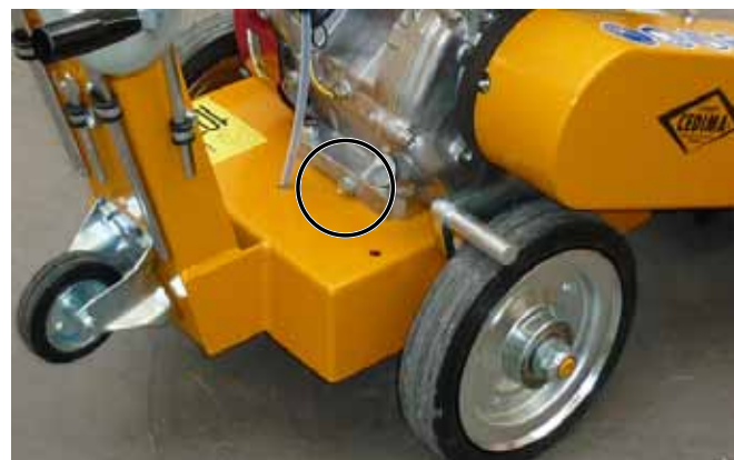
СВМ-35 В, Задний сливной винт моторного масла Рис. 6.9
