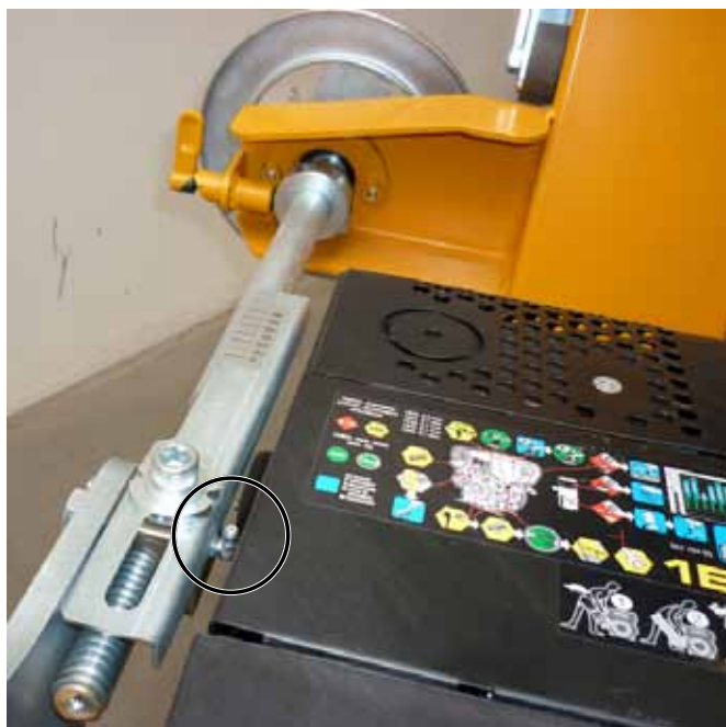
Пресс-масленка на механизме установки глубины
