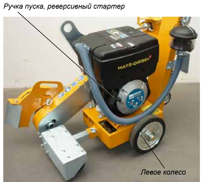
СВМ-35 D, Позиция для пуска реверсивным стартером Рис. 4.50
