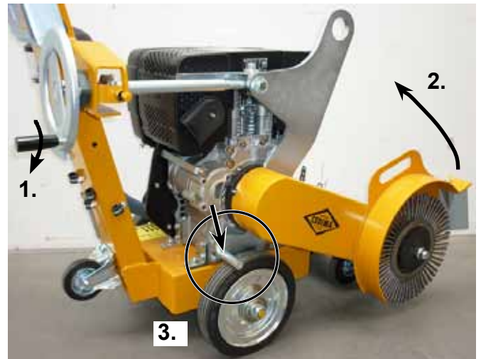
Приводной вал, щетка подняты, щеточная машина на стояночном тормозе
