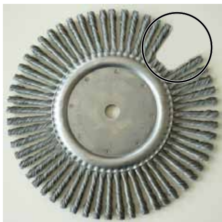
Замените дефектную, болтающуюся, имеющую некруговое вращение щетку Рис. 4.30
