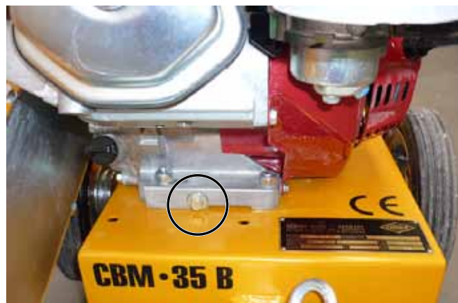
СВМ-35 В, Передний сливной винт моторного масла Рис. 6.8
