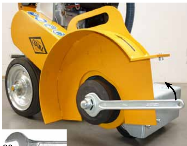
Отвинчивание гайки на валу щетки
