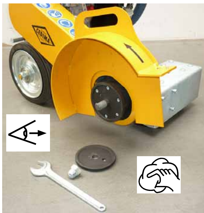
Гайка вала и прижимной фланец сняты
