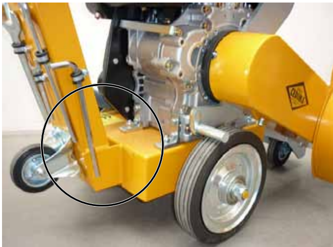
Место крепления на трубе рукоятки
