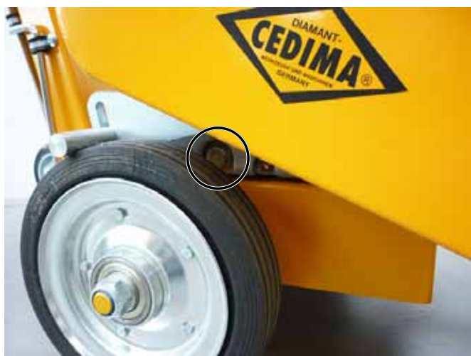
СВМ-35 D, Правый сливной винт моторного масла Рис. 6.11
